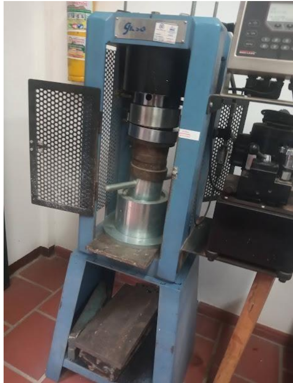
Figura 12. Instalación del material antes de ensayar.
