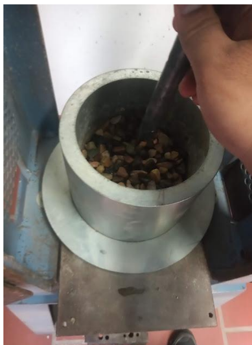
Figura 11. Compactación del material en la máquina de penetración.
