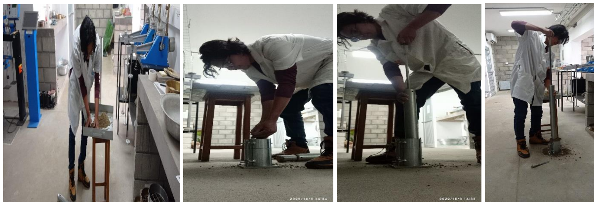
Figura 24. Secuencia ensayo modificado de compactación
