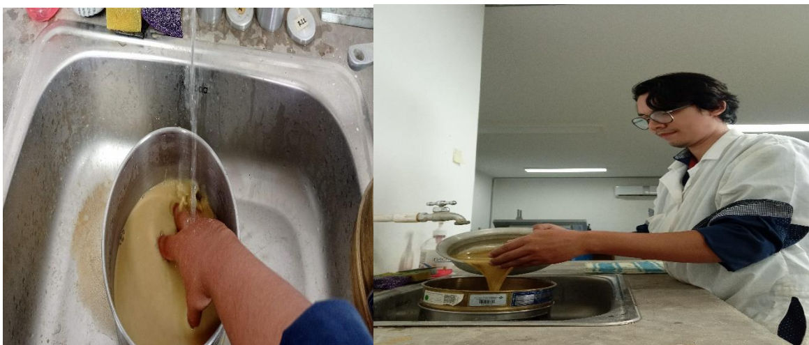
Figura 23. Procedimiento de ensayo de lavado sobre tamiz 200
