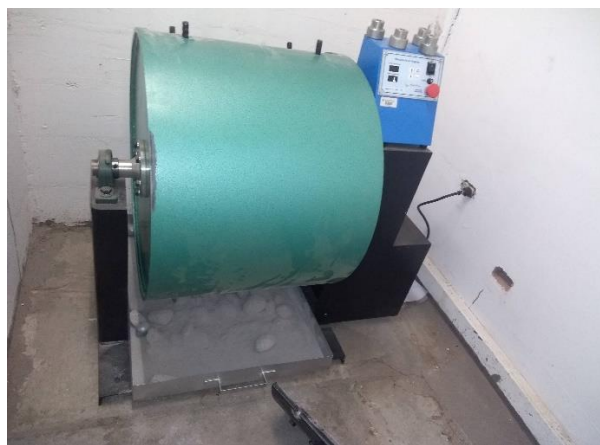
Figura 27. Polvo de pumita triturada por molino de bolas
