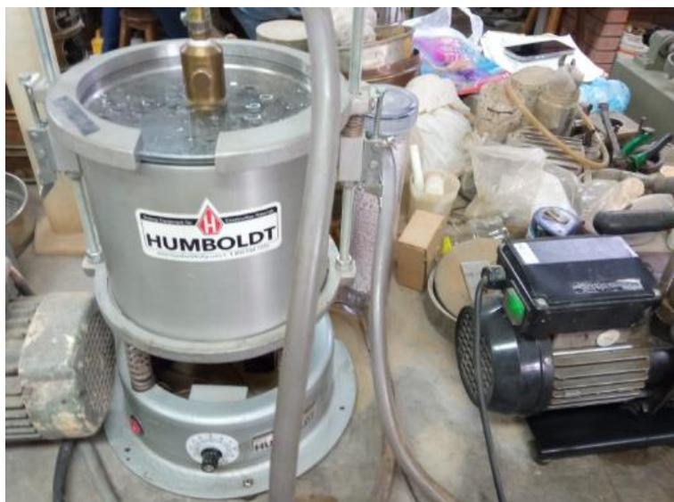
**Figura 18.** Picnómetro de vacíos.
