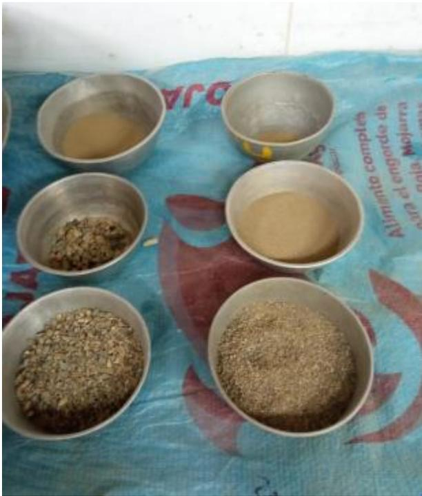
**Figura 7.** Separación de Granulometría de 3/8".
