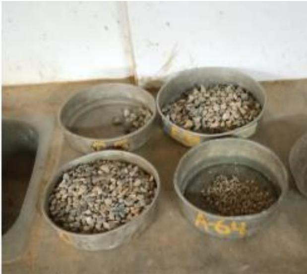
**Figura 9.** Separación de Granulometría de 1/2”.
