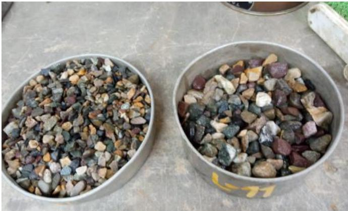
**Figura 10.** Laboratorio de caras fracturadas.
