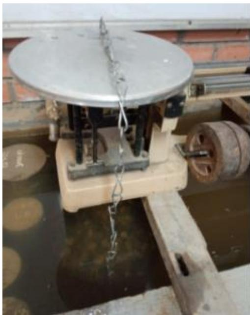
**Figura 11.** Gravedad específica y absorción de los agregados.
