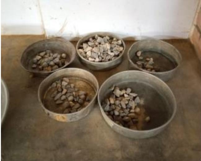
**Figura 8.** Separación de Granulometría de 3/4”.
