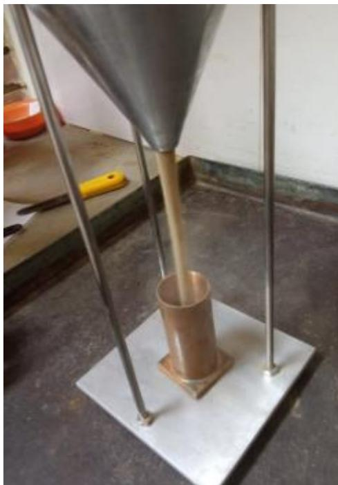
**Figura 15.** Ensayo de Angularidad.
