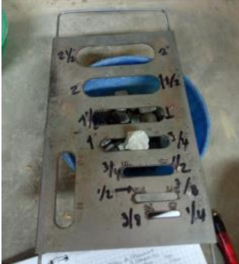
**Figura 12.** Calibrador proporcional.
