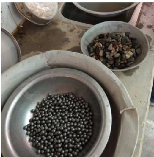
**Figura 14.** Esferas de acero para ensayo de Micro-Deval.
