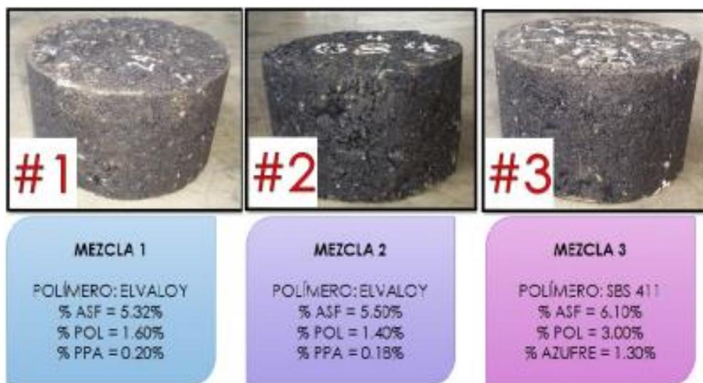
**Figura 2.** Mezcla asfáltica modificada
