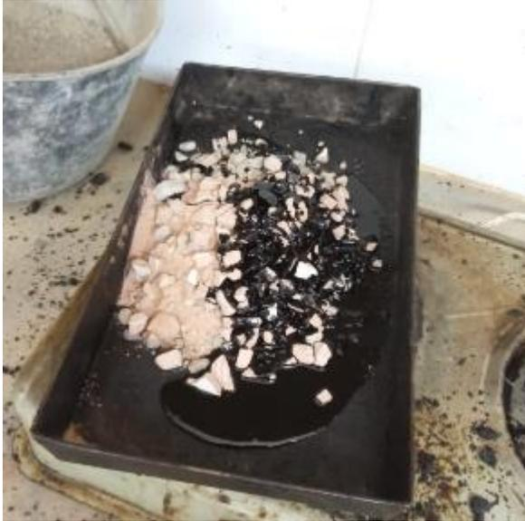
**Figura 16.** Mezcla de material pétreo, material cerámico y cemento asfáltico.
