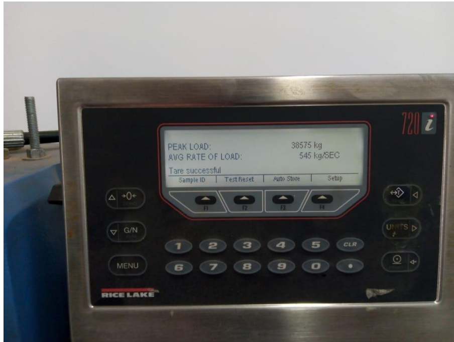
Figura 21. Carga de falla del cilindro número 8
