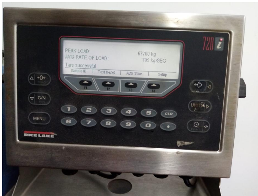
Figura 36. Carga de falla, cilindro número 11
