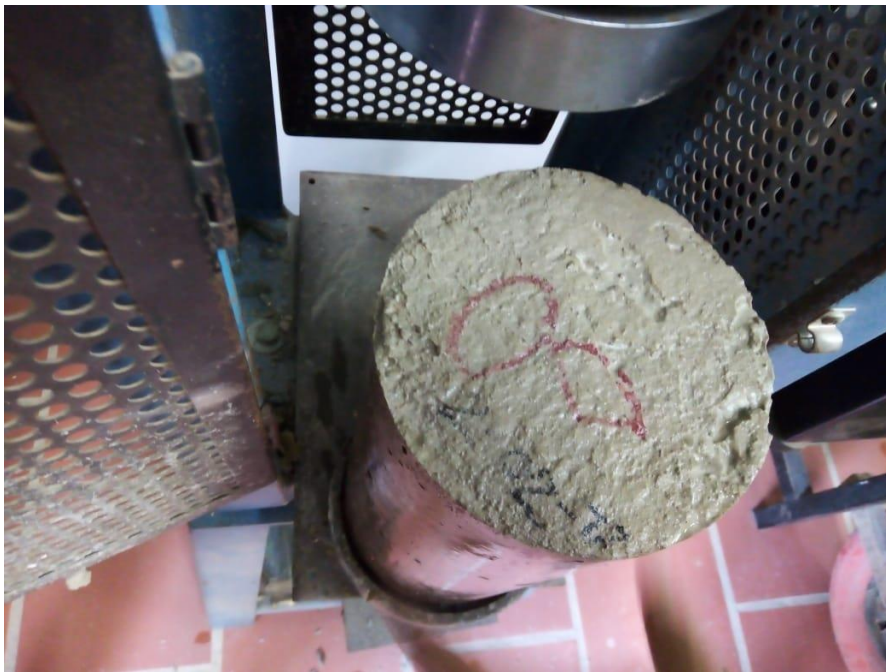
Figura 20. Numero 8 antes de ser ensayado a compresión
