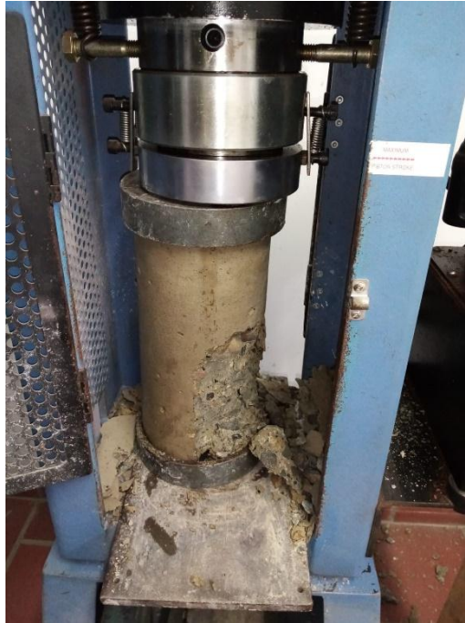
Figura 31. (Falla tipo 5) cilindro número 5
