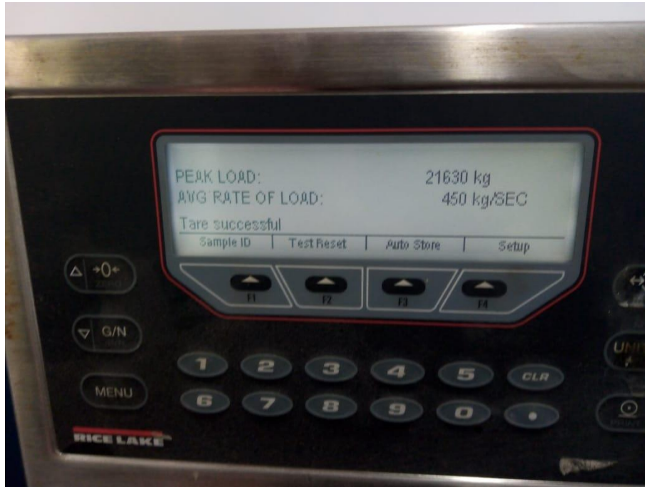
Figura 27. Carga de falla, cilindro número 18
