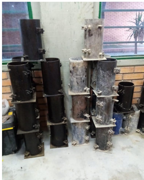
Figura 10. Limpieza y organización de los moldes metálicos a utilizar para la realización de los cilindros de concreto
