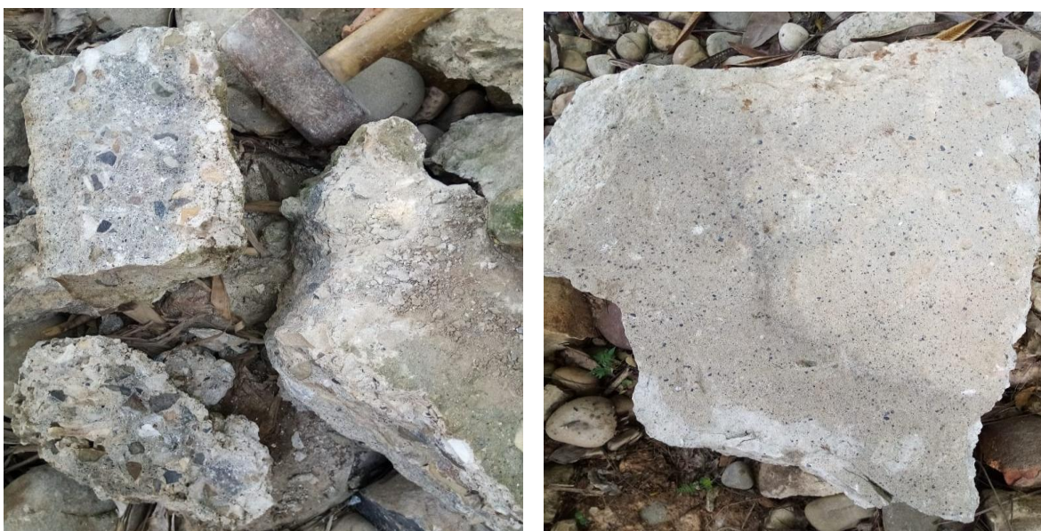
Figura 2. Material de demolición
