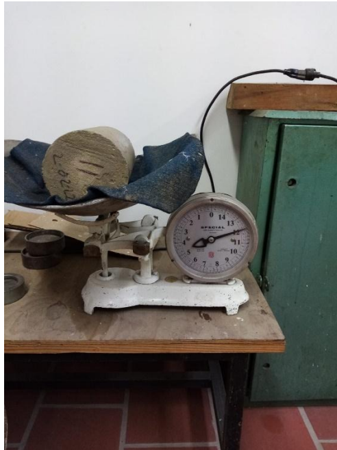
Figura 35. Cilindro número 11 antes de ser ensayado a compresión
