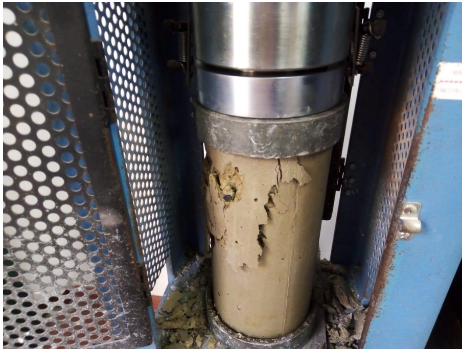
Figura 28. (Falla tipo 2) cilindro número 18
