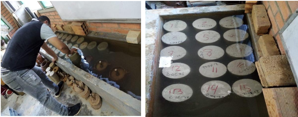
Figura 16. Inmersión de los cilindros de concreto para su respectivo curado
