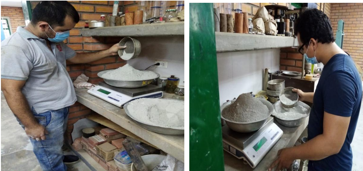
Figura 9. Dosificación de materiales dicha dosificación es realizada por peso
