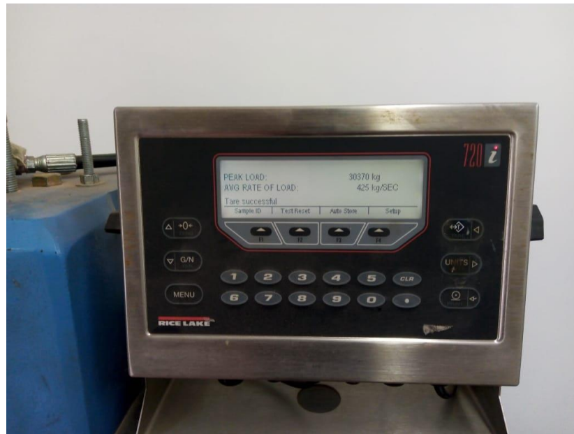
Figura 18. Carga de rotura del cilindro No.4
