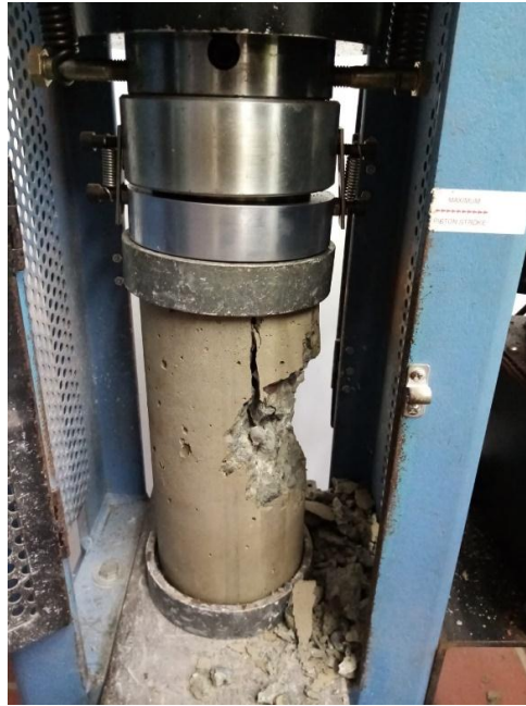
Figura 37. (Falla tipo 5) cilindro número 11
