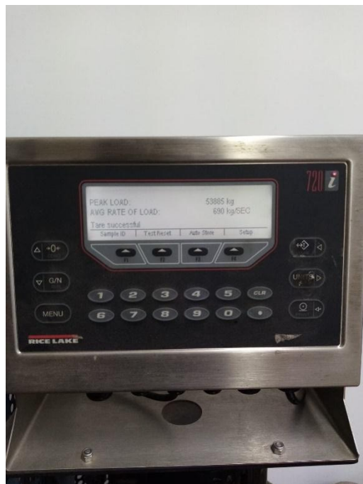
Figura 33. Carga de falla, cilindro número 6
