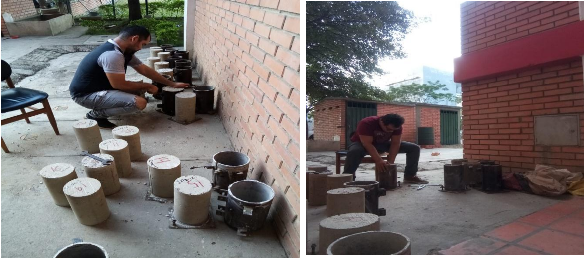
Figura 15. Desencofrado y rotulado de los cilindros de concreto
