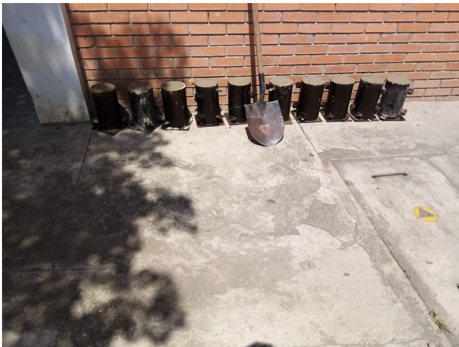
Figura 13. Cilindros concreto convencional y cilindros de concreto con material reciclado
