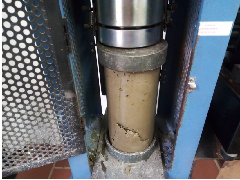
Figura 19. (Falla tipo 6) cilindro No. 4
