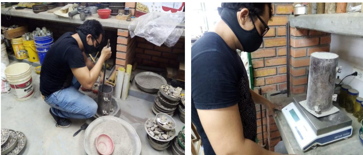
Figura 4. Ensayo peso unitario del material reciclado
