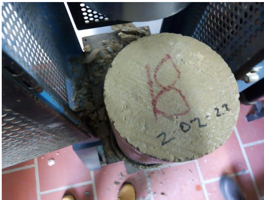
Figura 26. Cilindro número 18 antes de ser ensayado a compresión
