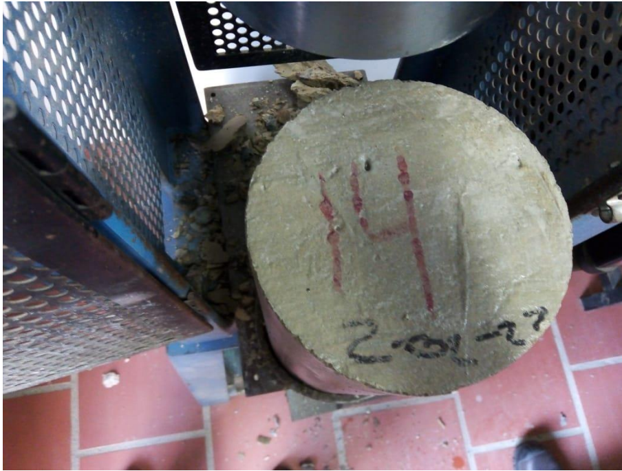
Figura 23. Cilindro número 14 antes de ser ensayado a compresión
