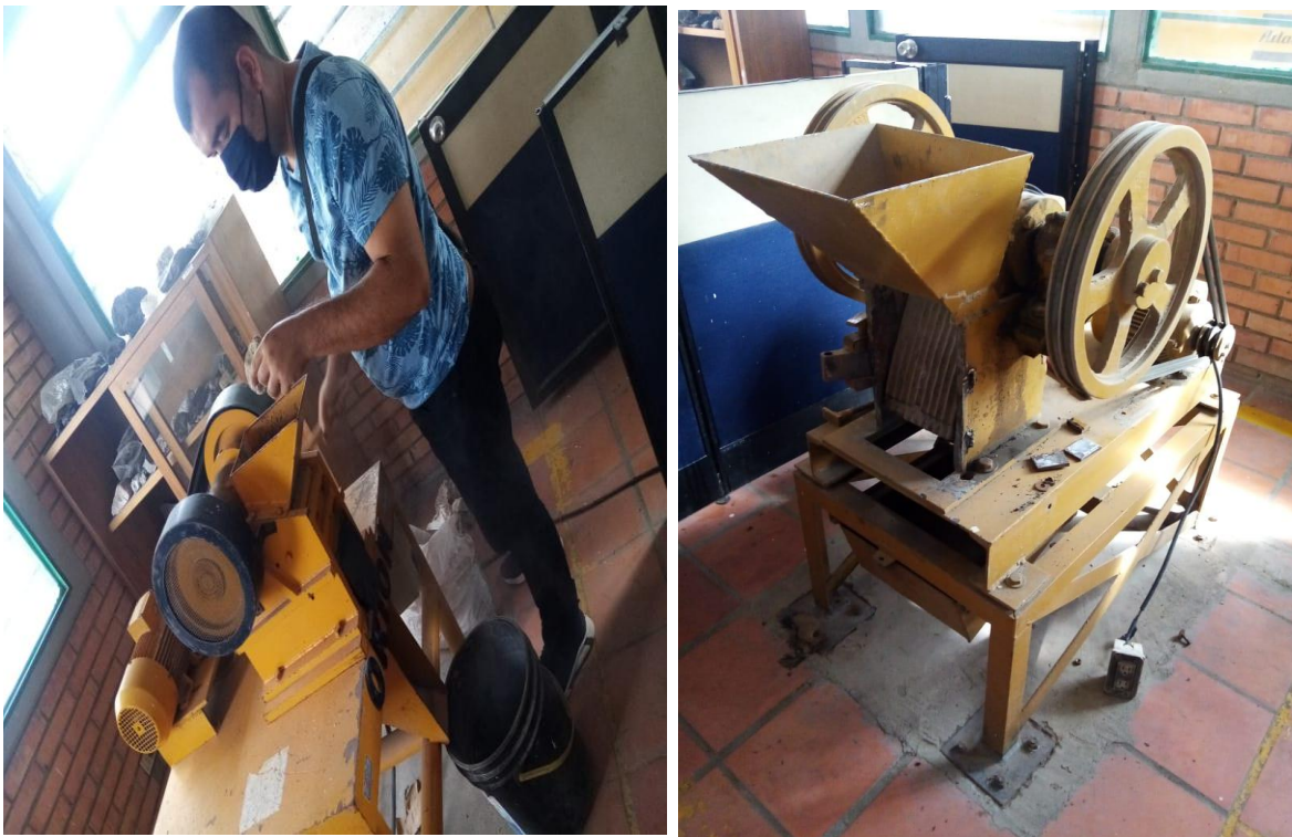
Figura 3. Proceso de trituración del material reciclado
