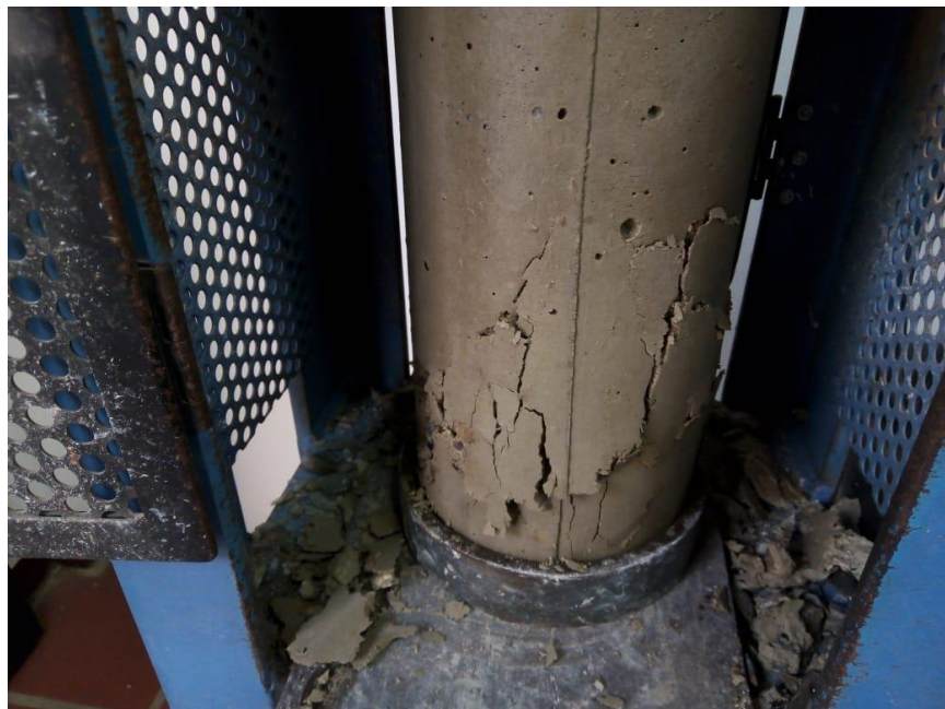
Figura 25. (Falla tipo 2) cilindro número 14
