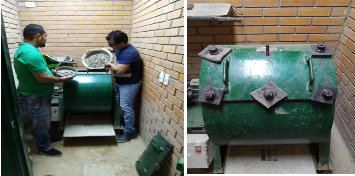
Figura 8. Laboratorio máquina de los ángeles norma E - 218
