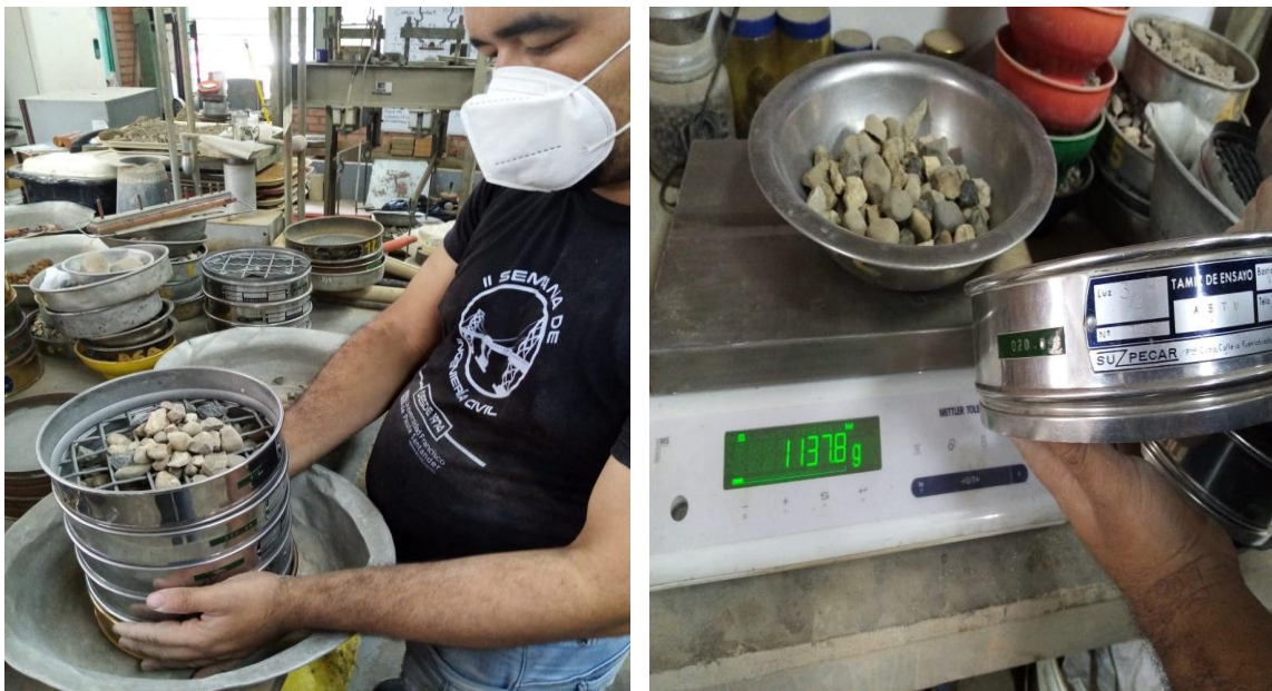
Figura 7. Granulometría de agregado grueso norma E - 123
