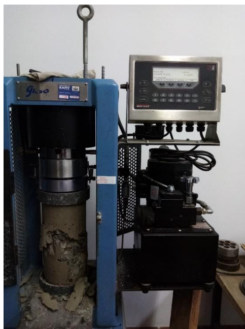
Figura 34. (Falla tipo 1) cilindro número 6
