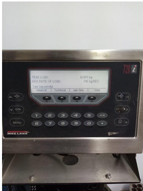
Figura 30. Carga de falla cilindro número 5
