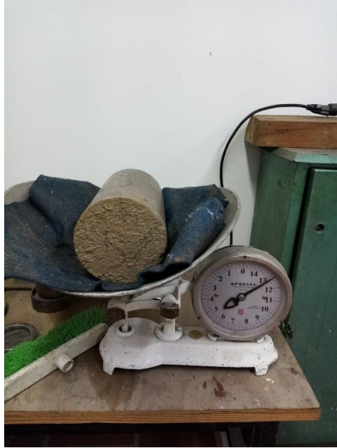
Figura 29. Cilindro número 5 antes de ser ensayado a compresión
