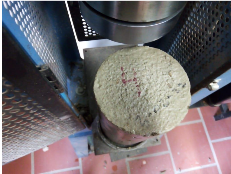
Figura 17. Cilindro No. 4 antes de ser ensayado a compresión
