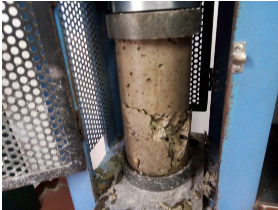
Figura 22. (Falla Tipo 1) cilindro número 8
