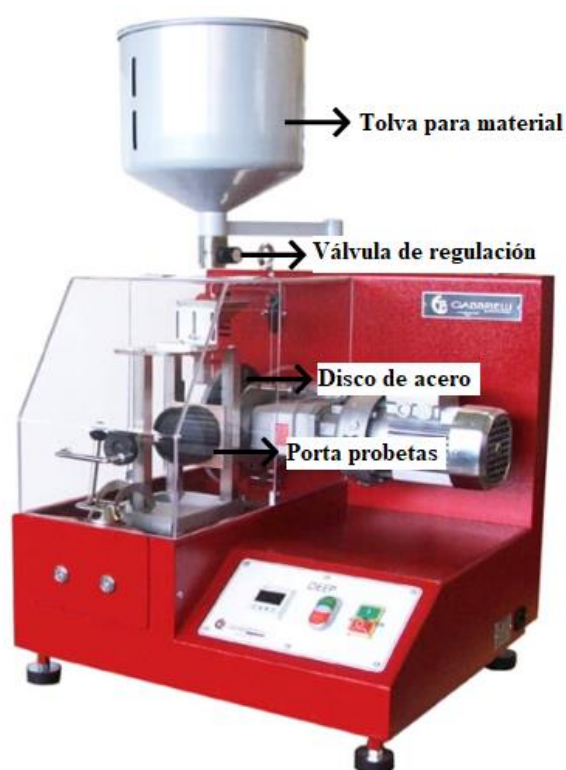
Figura 27. Abrasimetro marca Gabrielli Technology modelo Cap/3.
