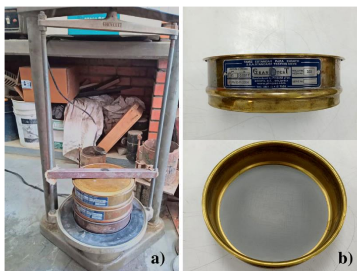
Figura 19. a) Sistema de tamizado y b) tamices
