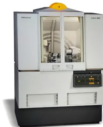
Figura 22. Equipo de difracción de rayos X marca XPERT-PRO
