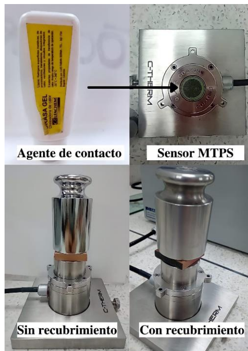
Figura 30. Agente de contacto, sensor MTPS, montaje del sustrato y de la muestra recubierta
