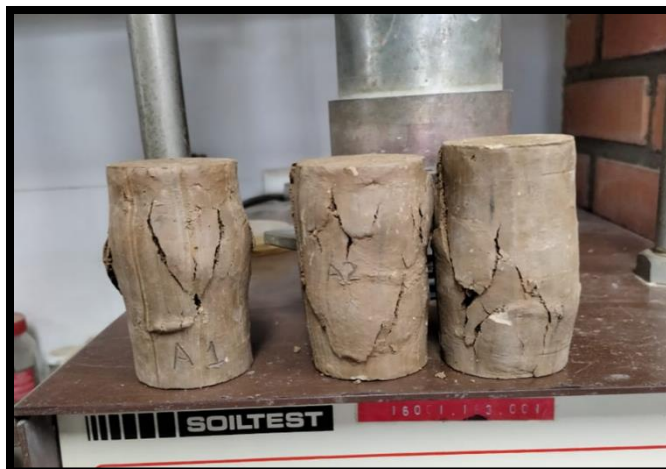
Figura 29. Laboratorio Resistencia al corte o a compresión
