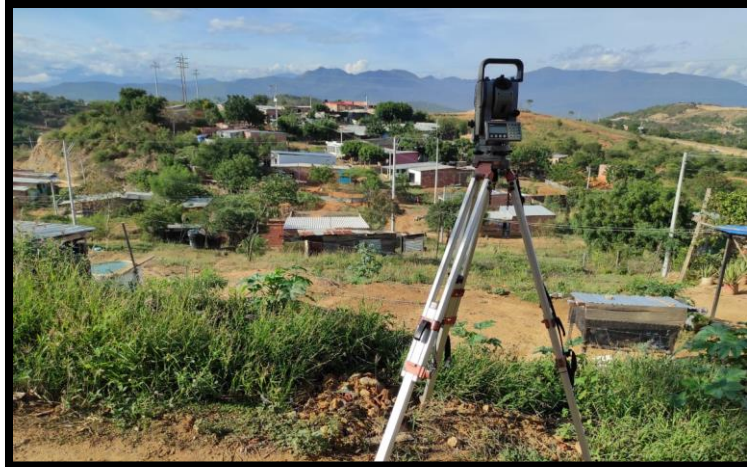
Figura 4. Estación total marca TOPCON GTS 255
