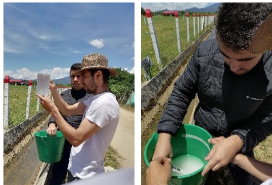
Figura 55. Preparación de la mezcla trazadora
