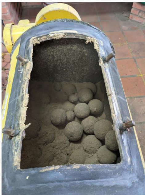
Figura 27. Molienda de hojas secas en molino de bolas
