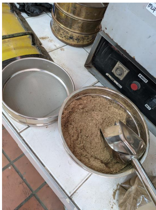
Figura 28. Tamizado de molienda en tamiz No.30
