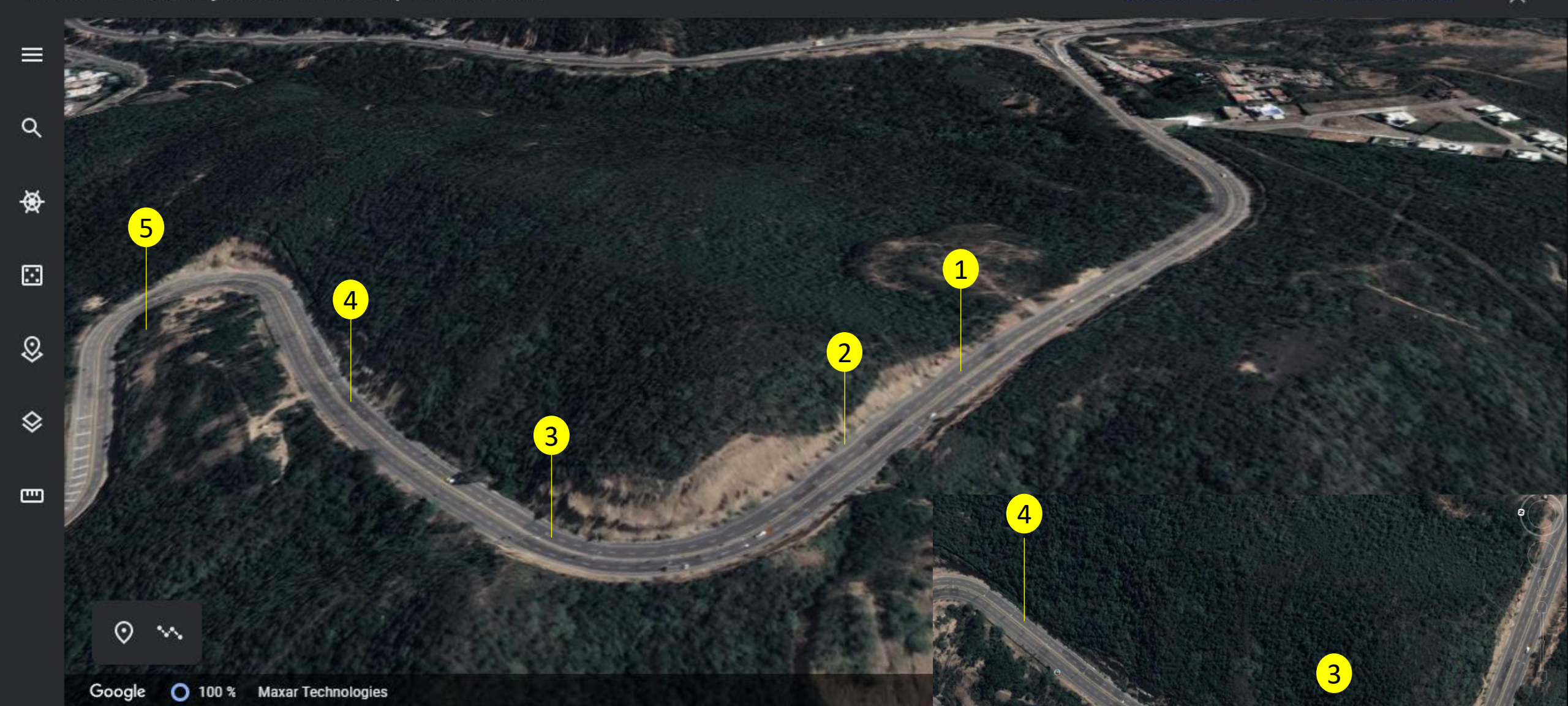
Puntos de observación de perfiles litostáticos - El tramo 3-4 presenta sección transversal mixta; parte en cajón y parte en balcón. Su geometría longitudinal es prácticamente recta. Álvaro Pedroza R –Junio 2021.
