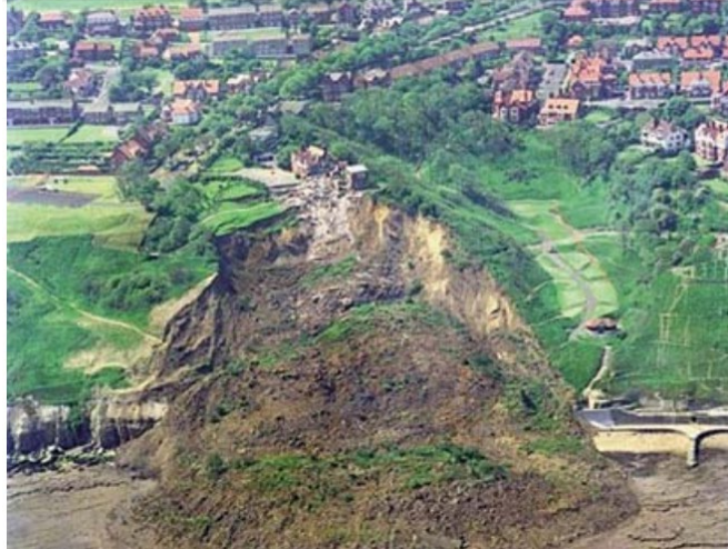
Figura 8. Deslizamiento rotacional de Holbeck al sur de Scarborough (UK) en 1993. Fuente: Servicio Geológico Británico.
