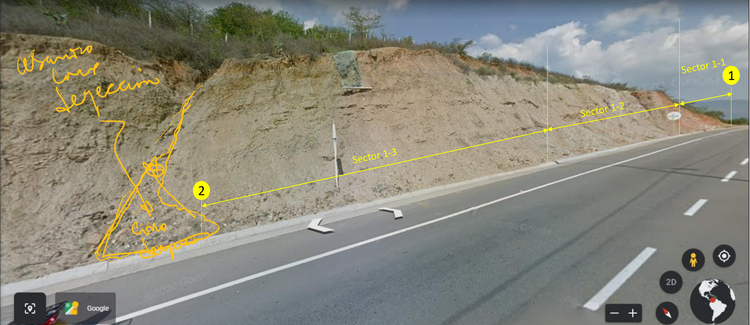
Panorámica del perfil litológico del subtramo 1-2. Se diferencian tres subsectores; el punto 2 está situado en proximidad a una cárcava erosiva con formación de salida de cono de deyección de los sólidos movilizados a través del acanalado erosivo natural
