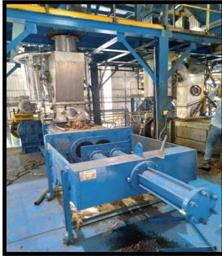
*Ilustración 2. Prensa Inal p-15. Fuente: Elaboración propia.*
