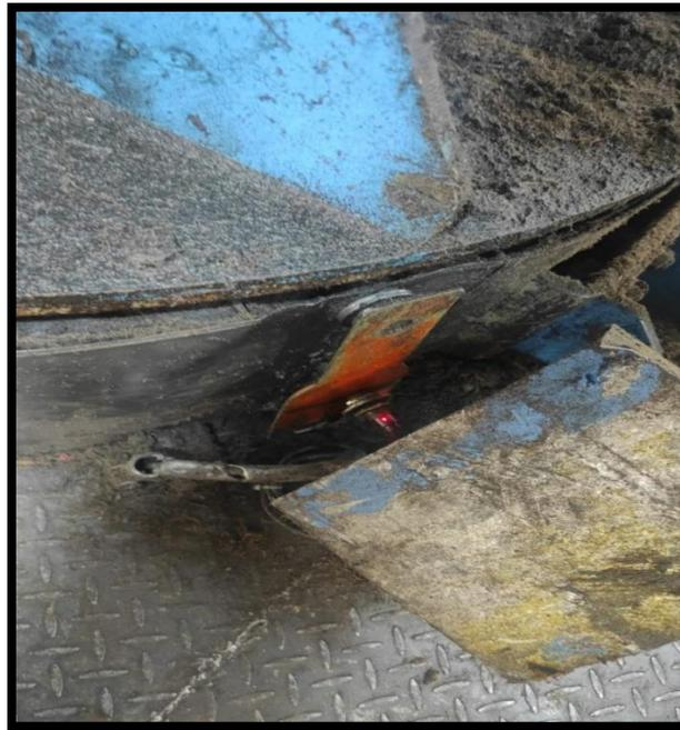
*Ilustración 21. Instalación del sensor y paleta. Fuente: Elaboración propia.*
