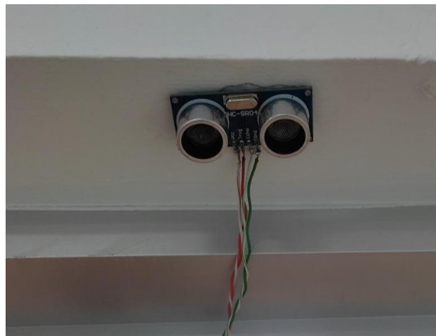
Figura 26. Ubicación sensor HC-SR04.
