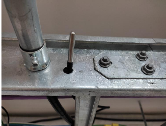
Figura 25. Ubicación del sensor DS18B20.
