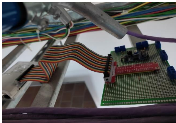
Figura 27. Ubicación Raspberry Pi y placa de conexiones.
