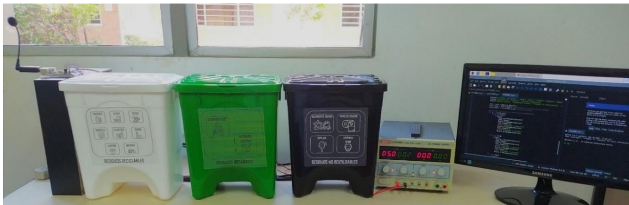
Figura 13. Montaje del sistema de contenedores controlados por voz, prueba N°4. Elaboración propia.
