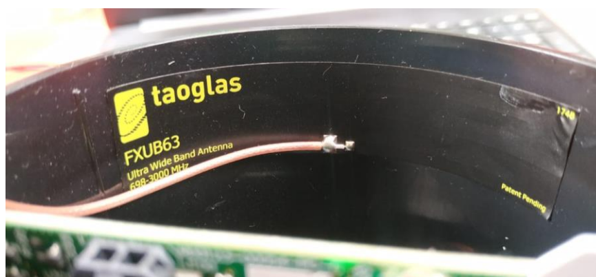
Figura 17. Antena interna del logger.
