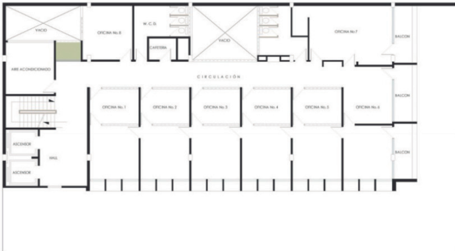
Figura 99. Planta del tercer piso del edificio del antiguo Banco de la República
