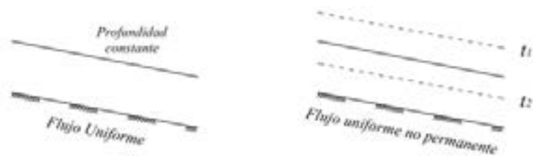
Figura 4. Representación de un flujo permanente y no permanente.
