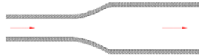
Figura 42. Transición con ampliación de ancho
