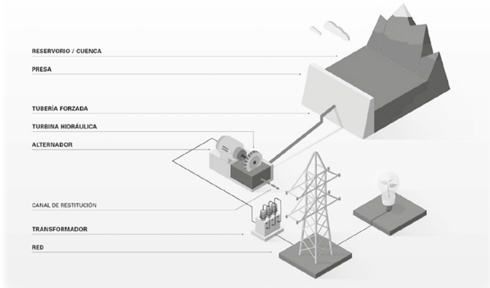
Figura 28. Funcionamiento de la energía hidroeléctrica.
