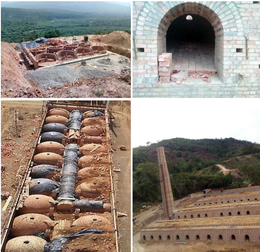
Figura 21. Características de hornos colmena para coquización de carbón
