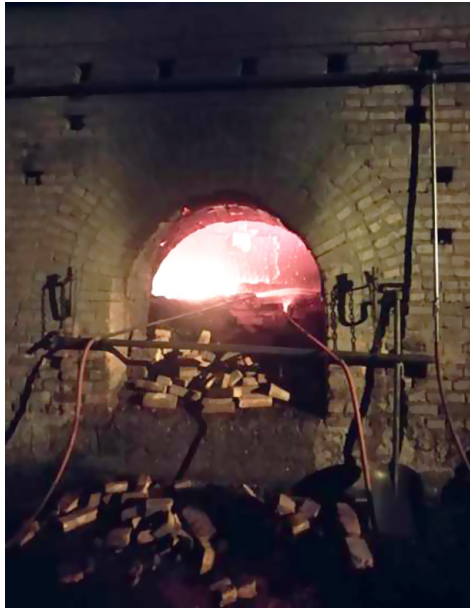
Figura 30. Apagado del horno colmena al finalizar el proceso de coquización
