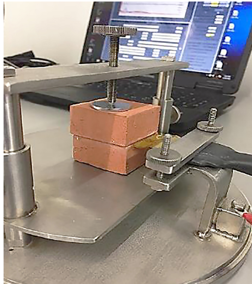
Figura 52. Montaje usado para medición de conductividad térmica
