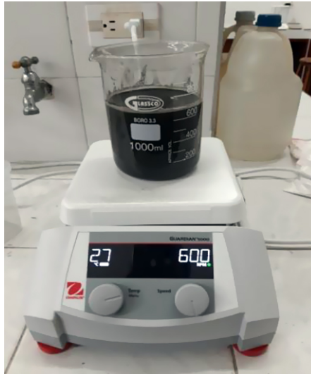
Figura 43. Ceniza de termoeléctrica durante el tratamiento con ácido fosfórico
