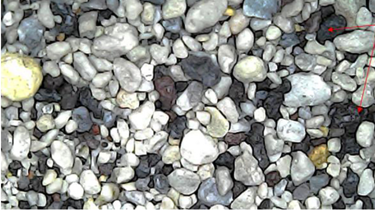
Figura 40. Microfotografía de cristales del material FC luego de lavado usando malla 230 tyler
