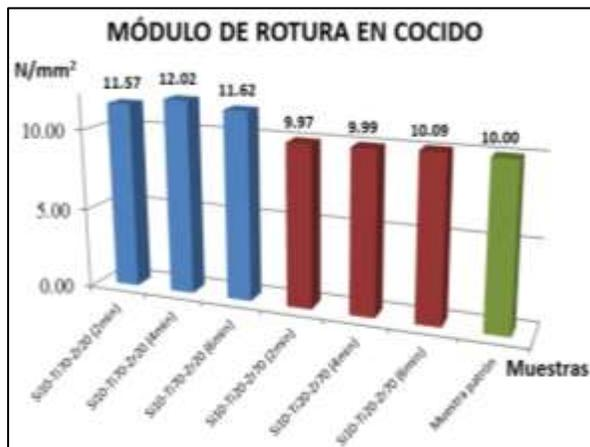
**Figura 6.** Módulo de rotura (resistencia mecánica a la flexión) de las muestras analizadas.
