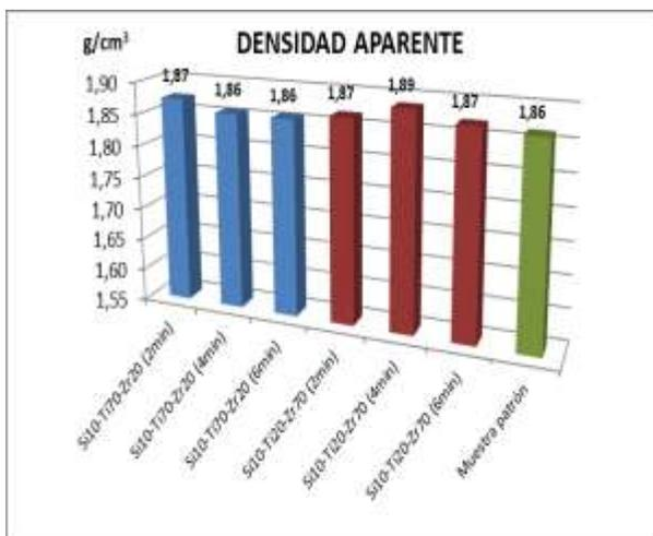
**Figura 8.** Densidad aparente de las muestras analizadas.
