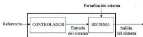
Figura 6. Sistema de control abierto.
