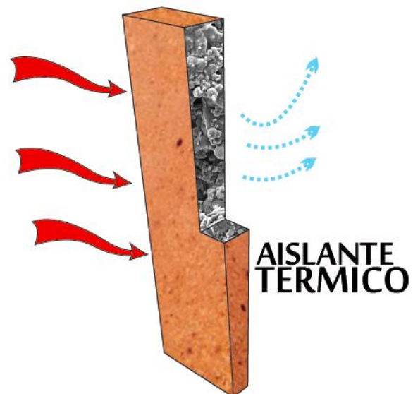
Figura 4. Sección de la pieza cerámica porosa. Micro porosidad, micro cámaras de aire.
