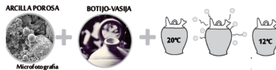
EFECTO BOTIJO = FACHADA VENTILADA
