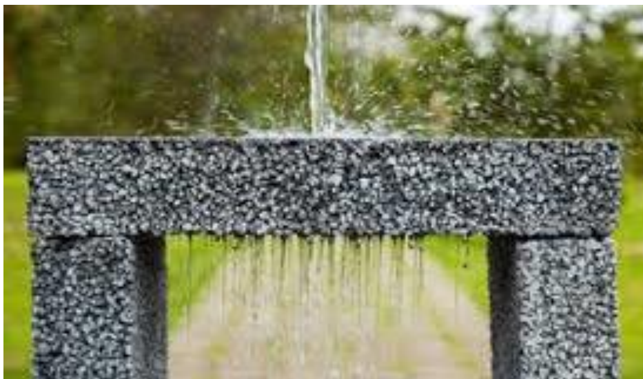
Figura 8.-Pavimento permeable- Concreto permeable
