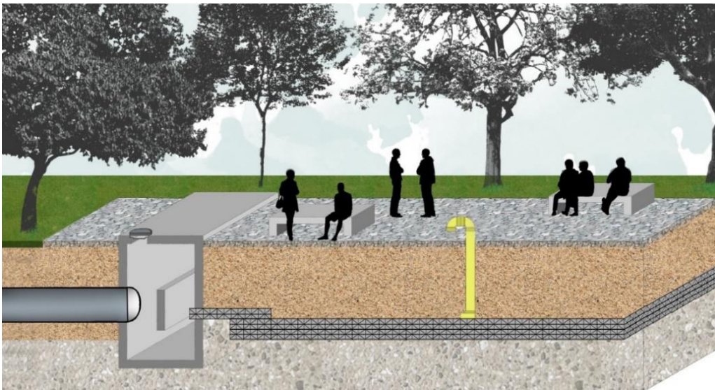
Figura 47. - Ambientación perfil estructura de infiltración
