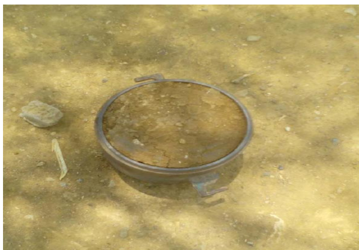
Extracción de la muestra de suelo inalterada
