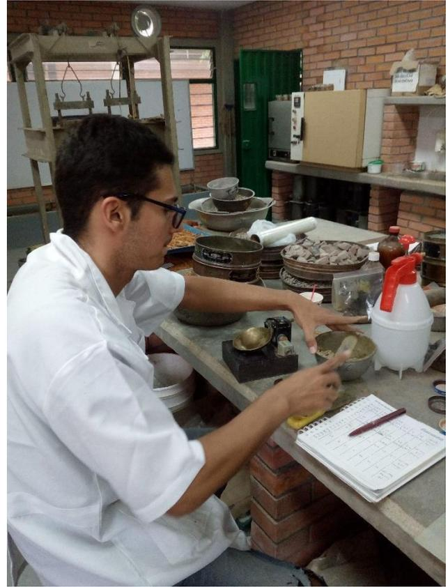
Fotografías 9 y 10. Ensayos de laboratorio limites de Atterberg.
