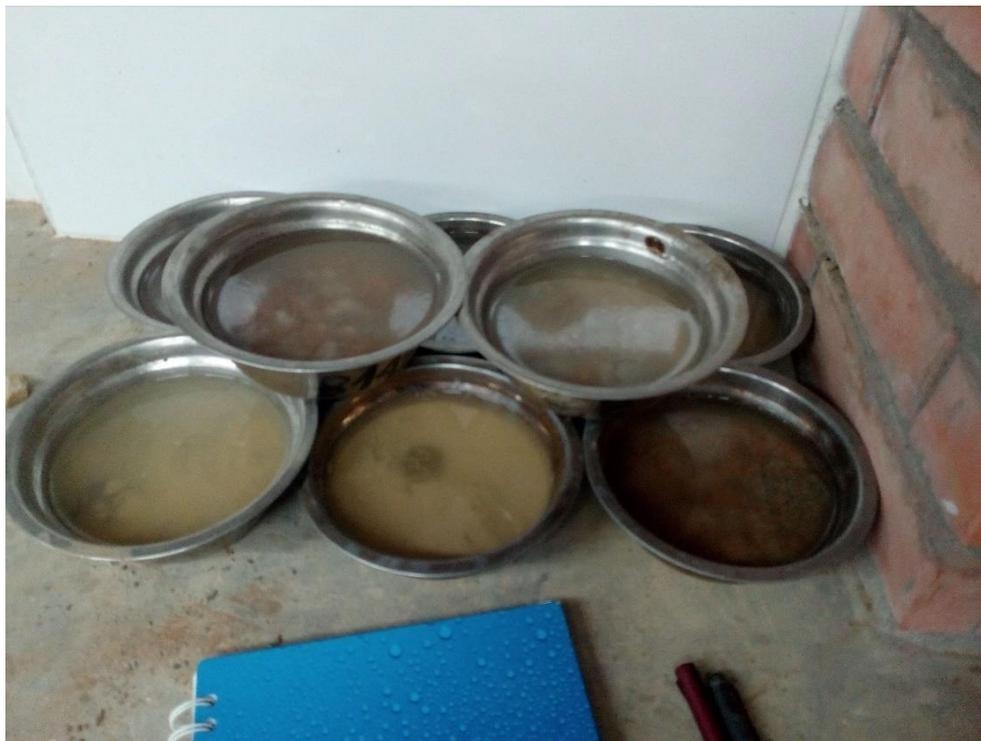
Fotografía 4. Preparación de las muestras para lavado previo a la clasificación.
