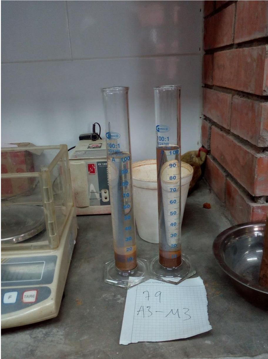
Fotografía 15. Ensayo de laboratorio, suelos expansivos, expansión libre en probeta
