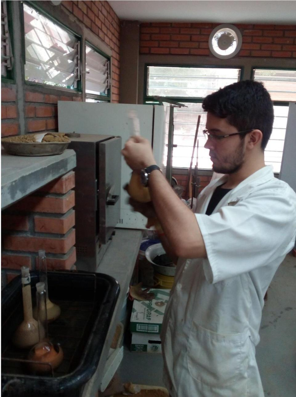
Fotografía 13. Ensayo de laboratorio, gravedad específica de los suelos
