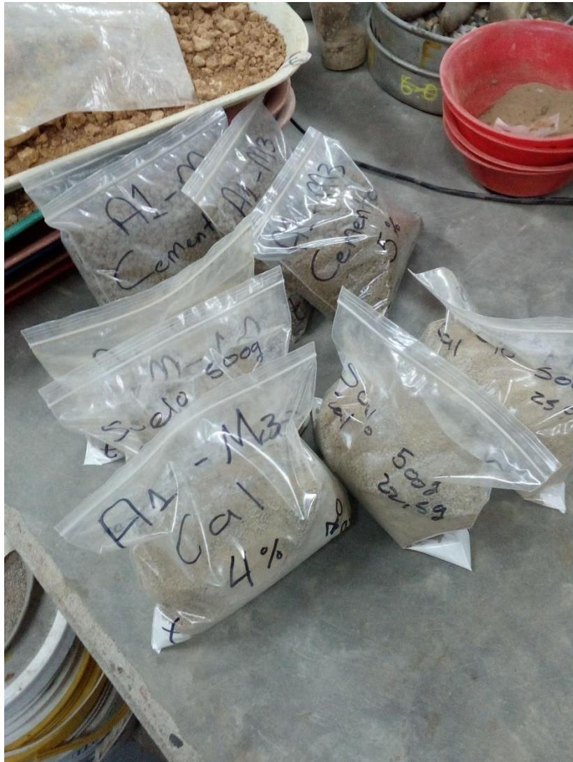
Fotografía 8. Separación de muestras con diferentes porcentajes de aditivos.
