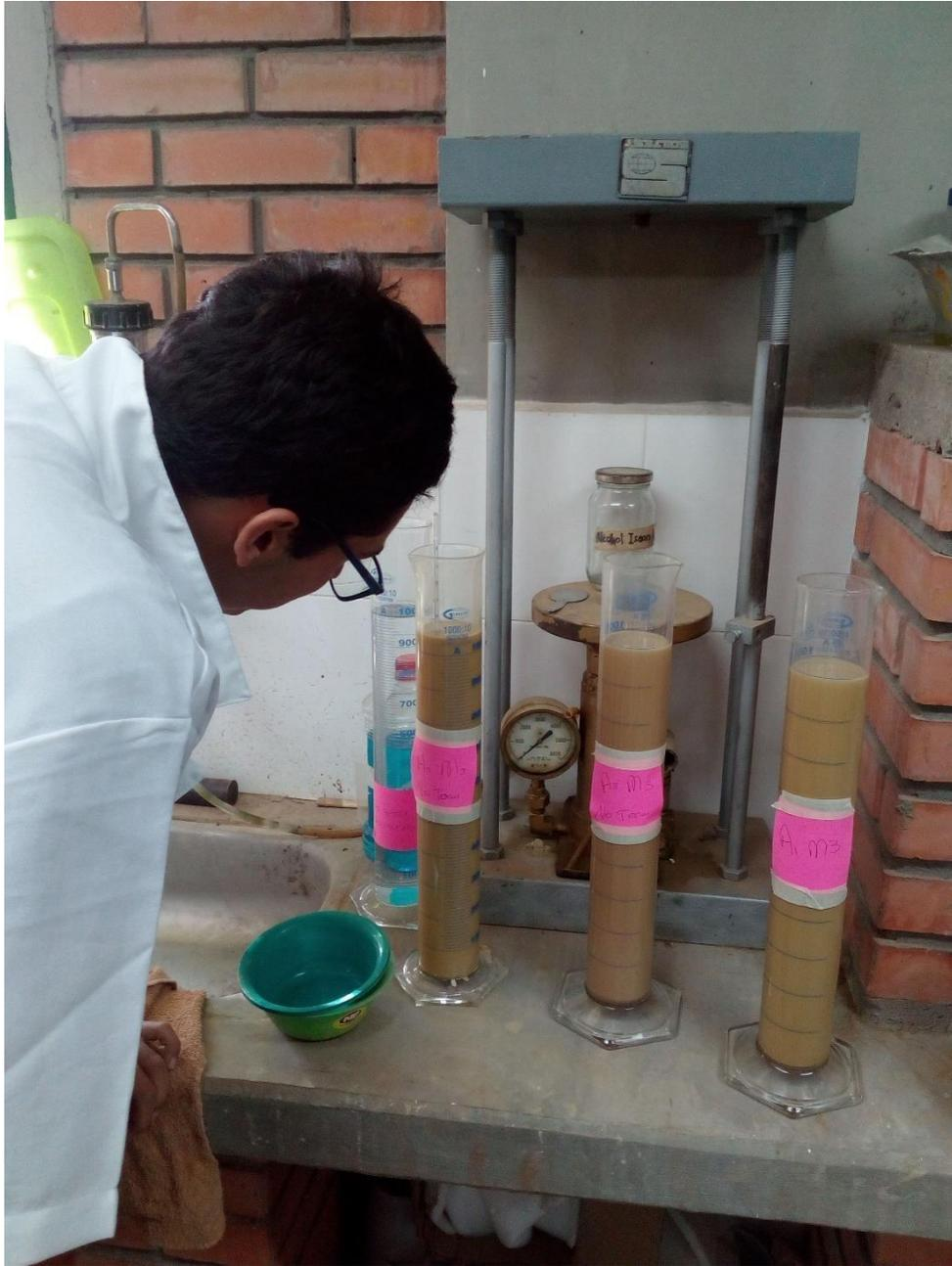
Fotografía 14. Ensayo de laboratorio, análisis granulométrico por hidrómetro
