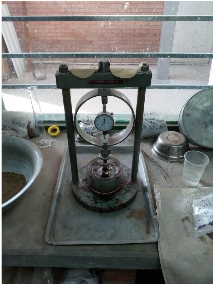
Fotografía 12. Ensayo de laboratorio Presion de expansión en el aparato de lambe.
