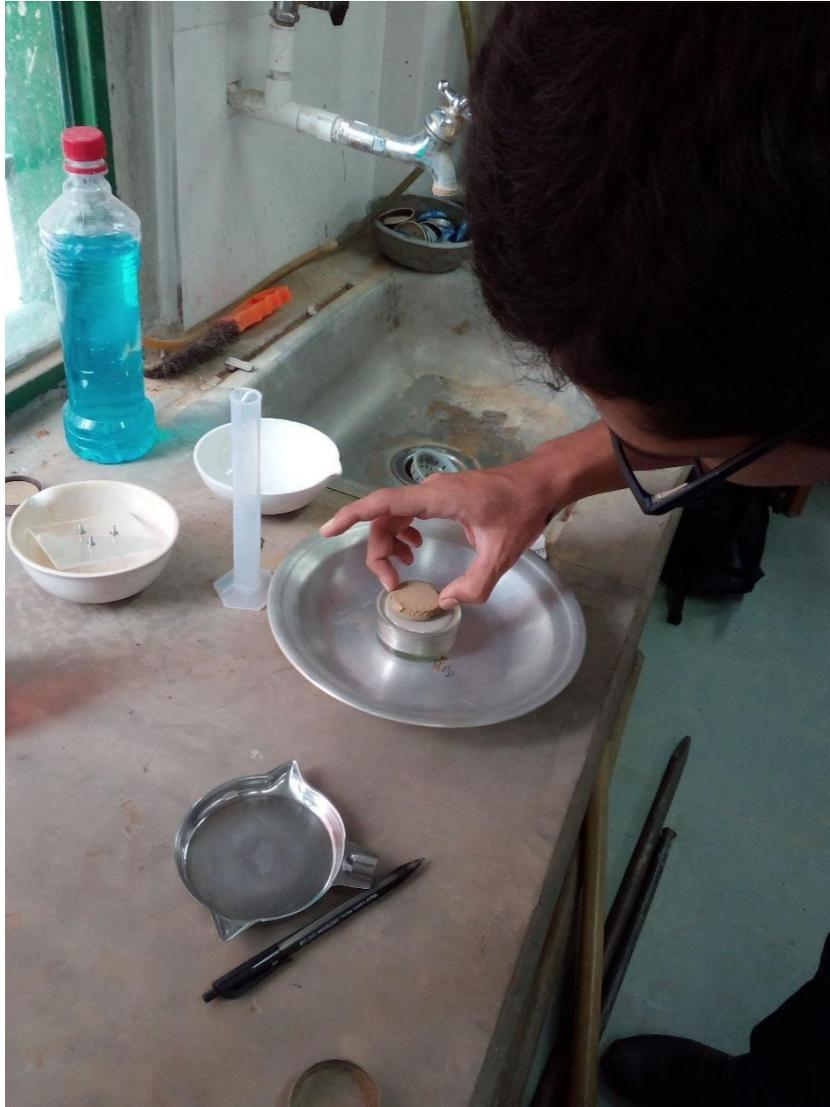
Fotografía 11. Ensayo de laboratorio Límites de contracción.
