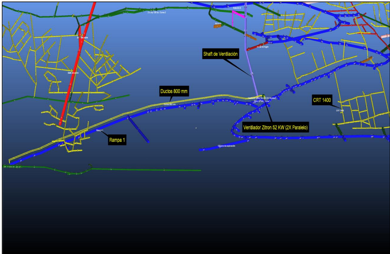
Ilustración 37. Sistema de ventilación propuesto.
