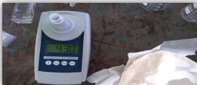
**Figura 4. Medición de la concentración espermática del eyaculado por medio del espectrofotómetro de luz**
