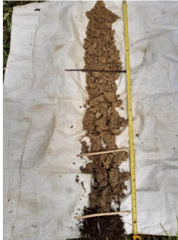
Ilustración 5 Construcción de columna de suelo
