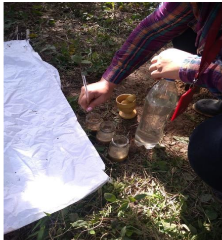
Ilustración 6 Prueba de pH y conductividad eléctrica en campo
