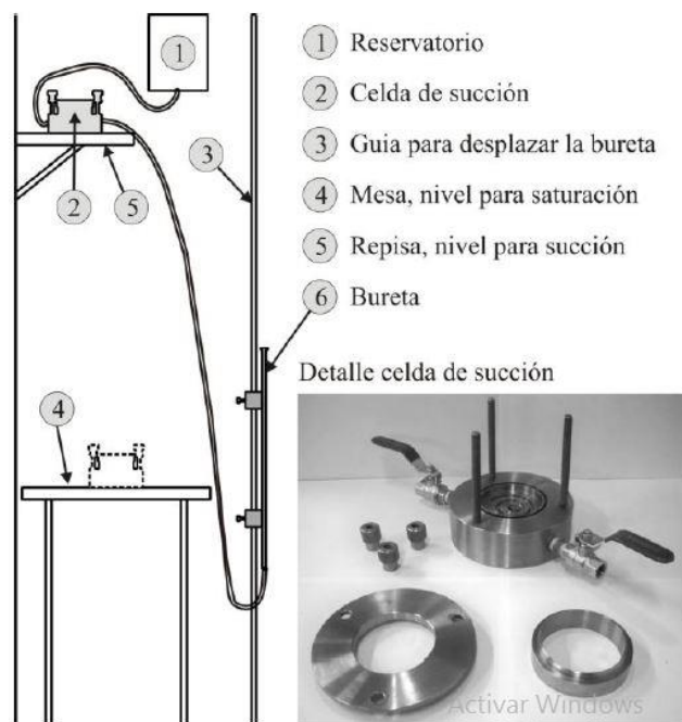
Figura 4. Equipo para ensayo de placa de succión.
