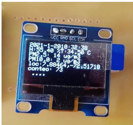
Figura 41. Pantalla de visualización de datos
