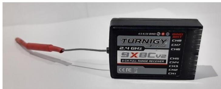
Figura 26. Modulo receptor Turnigy 9X8c-V2.
