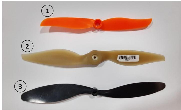
Figura 19. Hélices de prueba.
