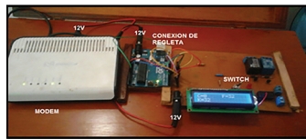
Figura 56. Banco para el monitoreo y el control de temperatura
