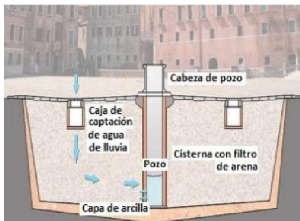
Figura 1. Esquema representativo de las cisternas de aguas lluvias construidas en Venecia
