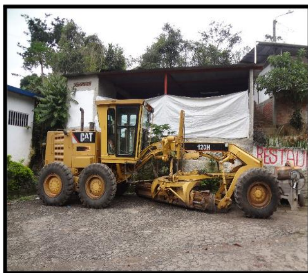
Figura 31. Maquinaria pesada, motoniveladora
