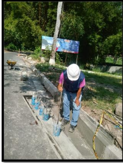
Figura 93. Cilindros de prueba para comprobar la resistencia del concreto
