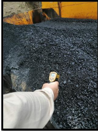
Figura 72. Toma de temperatura ( \pm 150\text{ C}^\circ )
