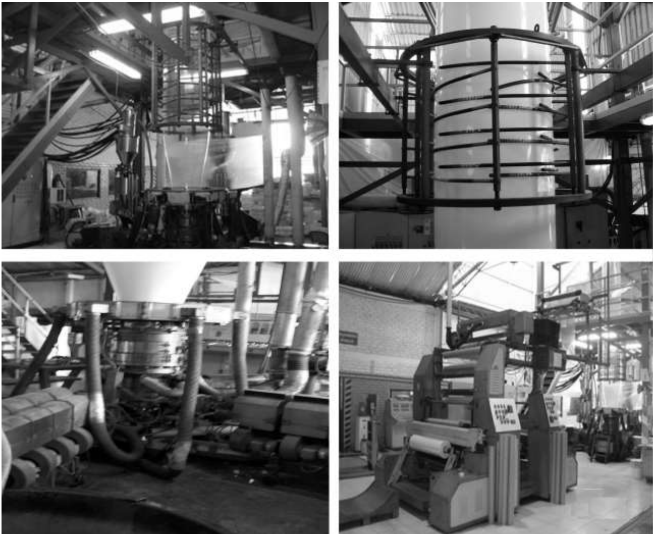
Fig. 3: Fotografías de la extrusora Ghioldi 1130
