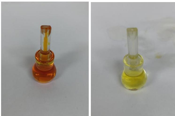
**Figura 54.** Medición de densidad con el picnómetro.
