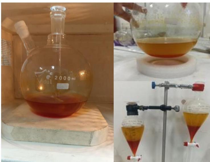
**Figura 68.** *Etapa de producción y separación del biodiesel y la glicerina.*
