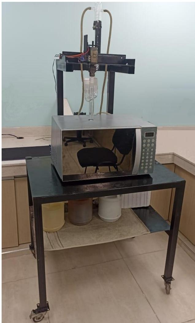
**Figura 17.** Banco de pruebas para la producción de biodiesel por radiación de microondas.
