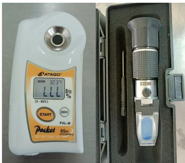
**Figura 66.** Equipos utilizados para calcular el índice de refracción.
