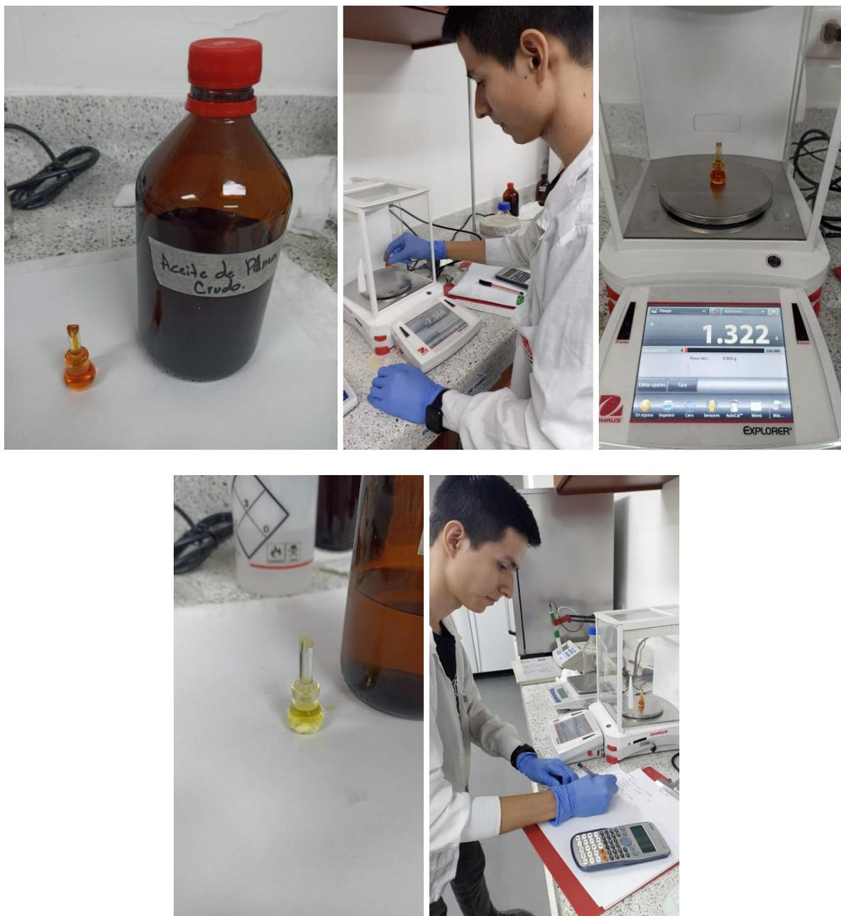
**Figura 69.** Prueba de densidad: aceite y biodiesel.
