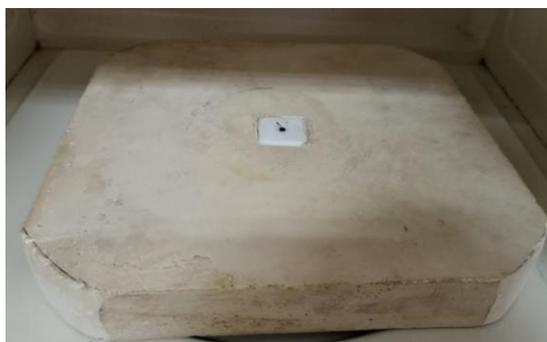
**Figura 18.** *Base del sensor de temperatura para el reactor: Diseño en SolidWorks e implementación.*
