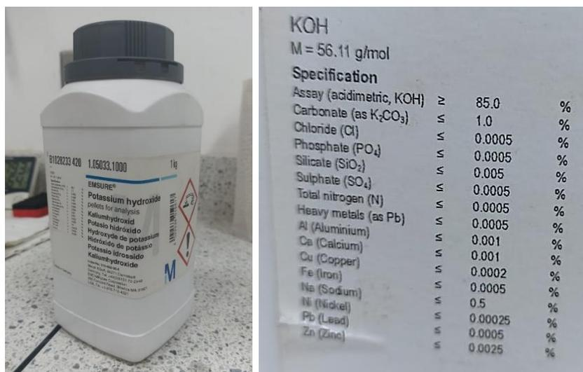
**Figura 12.** *Hidróxido de potasio al 85% de pureza.*
