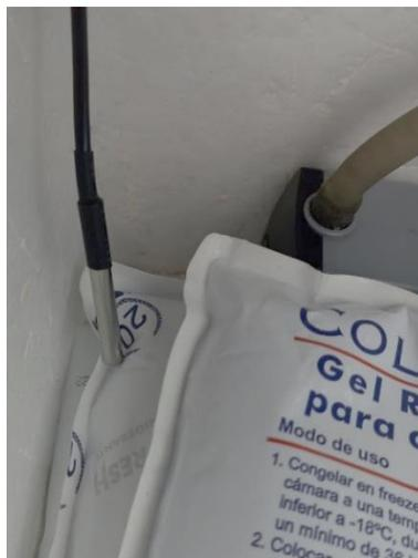
**Figura 19.** *Sensor de temperatura para el agua del condensador.*
