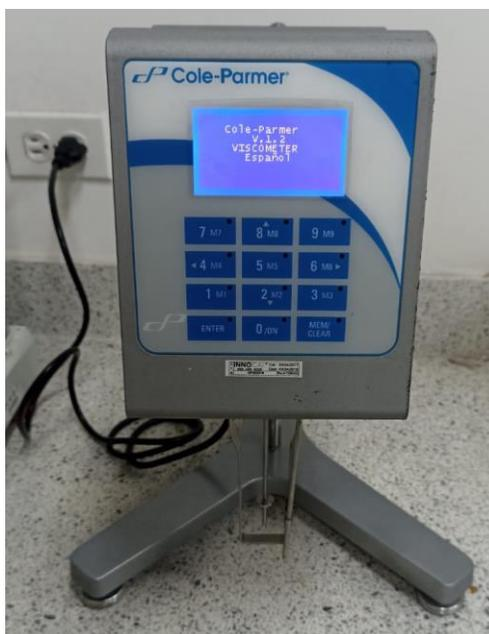
**Figura 55.** Viscosímetro rotacional Cole-Parmer utilizado en las mediciones.
