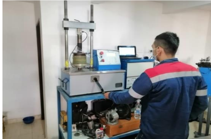
Figura 17. Ensayo a la compresión inconfiada
