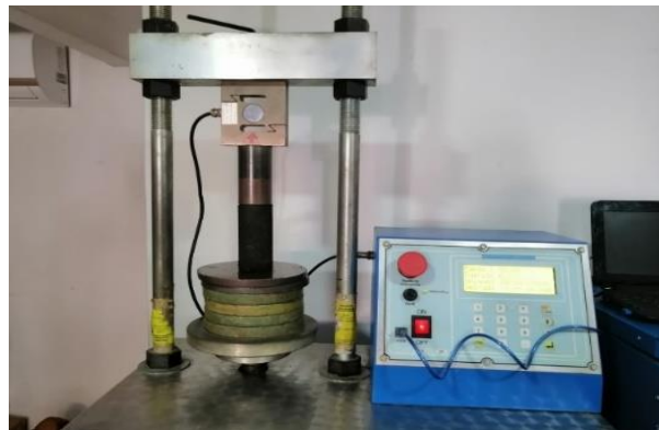
Figura 16. Ensayo a la compresión inconfiada
