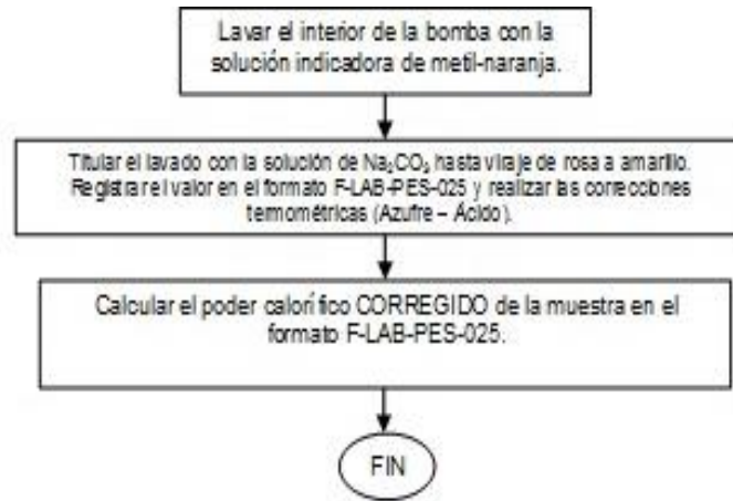
Figura 2. Procedimiento para medir el poder calorífico
