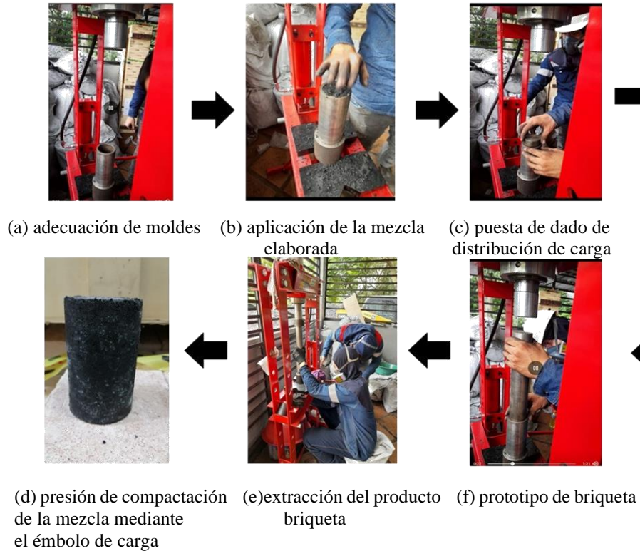
Figura 13. Proceso de compactación
