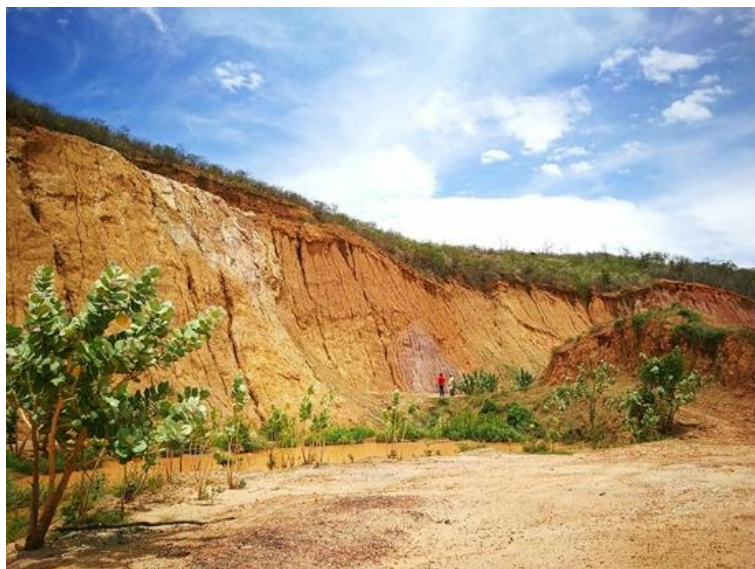
Figura 5. Frente de Explotación de la Arcilla (Cerámica Támesis S.A.)
