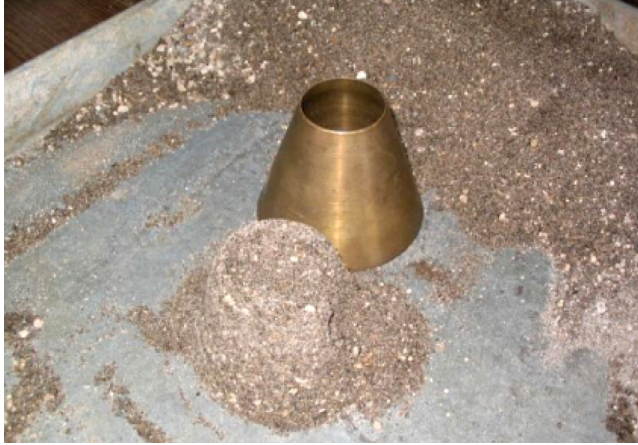
Figura 43. Muestra con la saturación requerida
