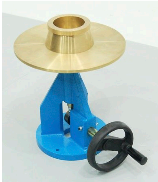
Figura 23. Mesa de fluidez del concreto
