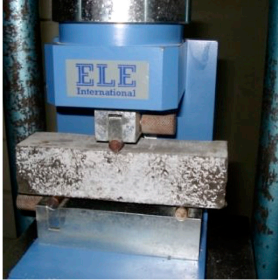
Figura 26. Ensayo de resistencia a tracción por flexión
