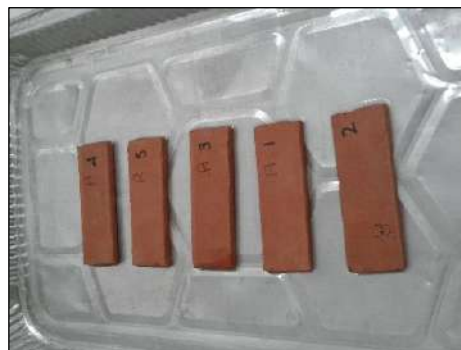
Figura 127. Aplicación ensayo de eflorescencia
