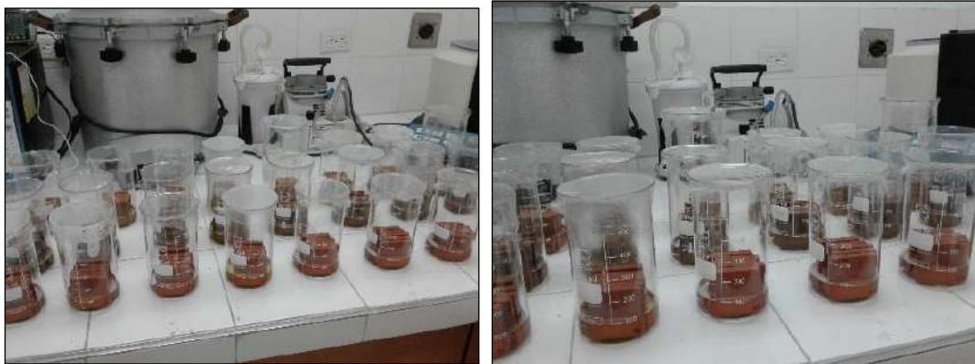
Figura 122. Aplicación ensayo de resistencia química
