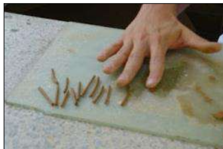
Figura 86. Método de Atterberg – Límite plástico
