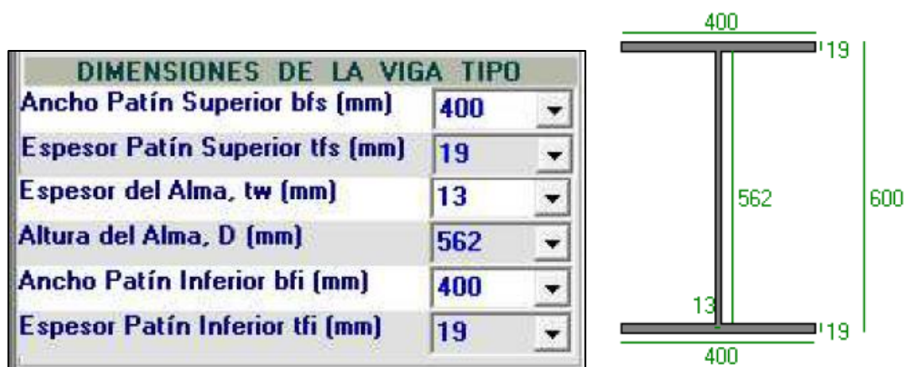
Figura 31. Especificaciones del perfil metálico solicitadas por el software.
