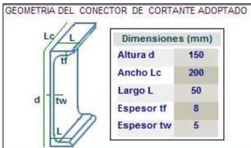
Figura 56. Detalle de los conectores de cortante. Fuente: Extraída del software de puentes.
