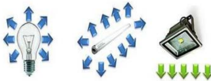
Figura 38. Flujo Luminoso de Diferentes Luminarias
