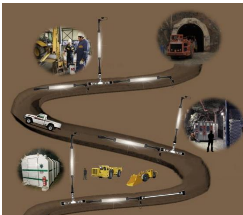
Figura 46. Sistema de iluminación con cintas led
