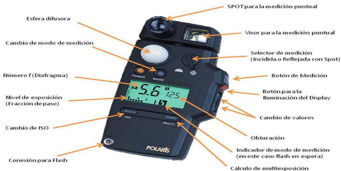
Figura 1. Partes de un fotómetro
