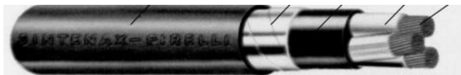
Figura 52. Cable con aislamiento de PVC, armado con flejes bajo cubierta también de PVC, tipo SINTENAX F para baja tensión
