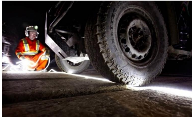
Figura 45. Resistencia a la compresión de la cinta led
