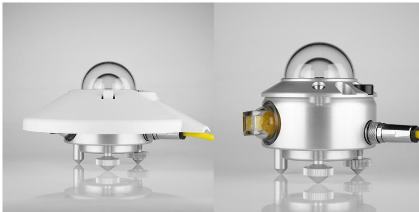
Figura 3. Piranómetro CMP6. Tomado de [23].
