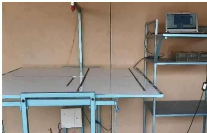
Figura 23. Implementación máquina de corte con alambre caliente.
