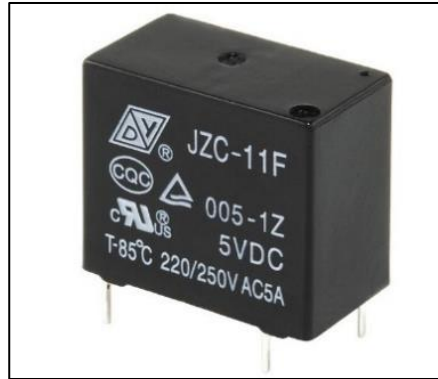
Figura 13. Relé comúnmente usado en proyectos electrónicos.
