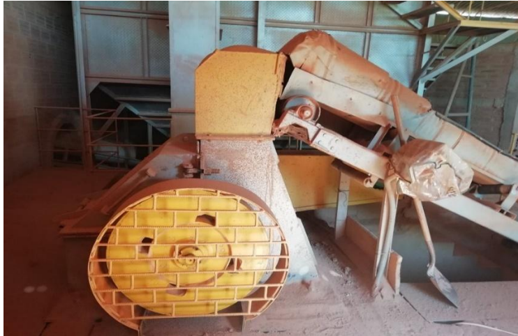
Figura 5. Zona de molienda, molino de martillos
