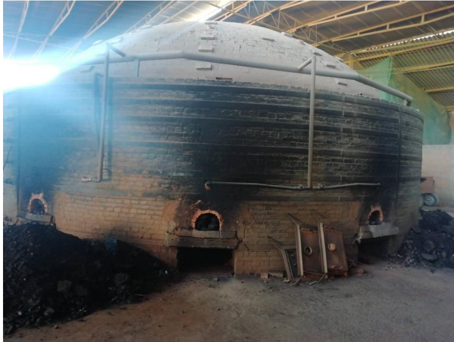
Figura 11. Zona de quema horno tipo colmena
