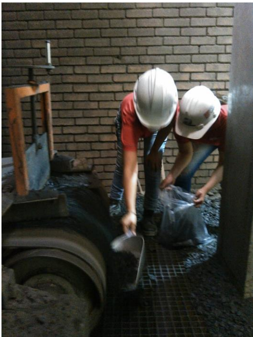
Figura 12 Toma de muestra en la descarga de la banda transportadora
