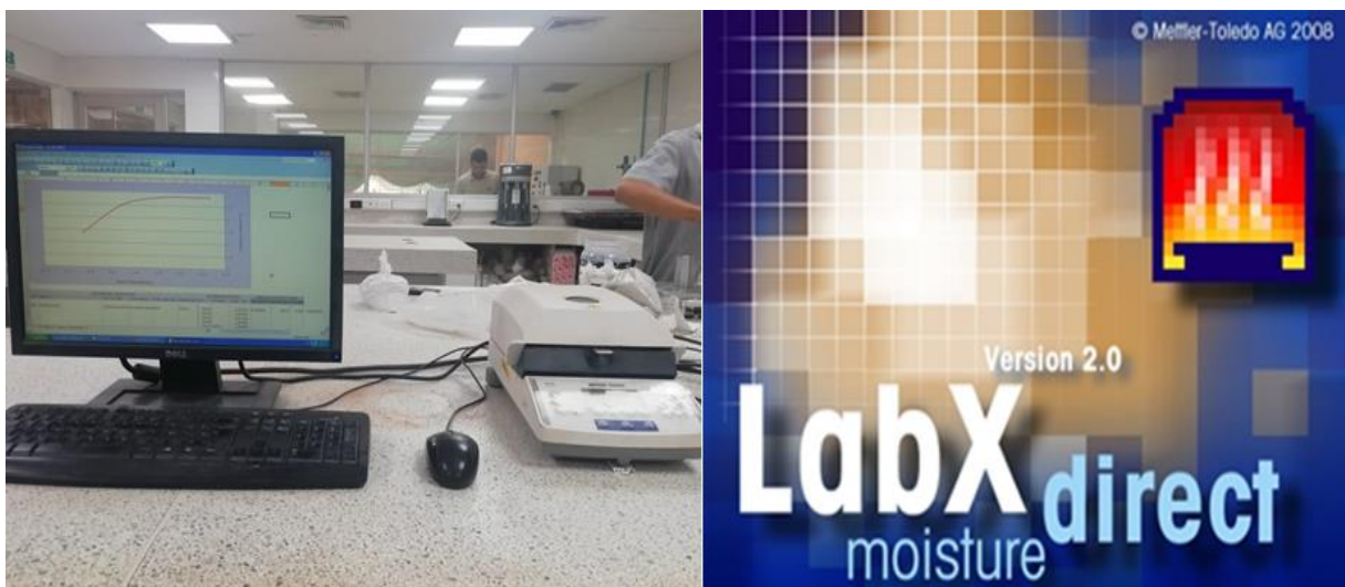
Figura 14 Balanza (METTLER TOLEDO HB-43), configurada al computador con el software (Labx Direct Moisture 2.2)
