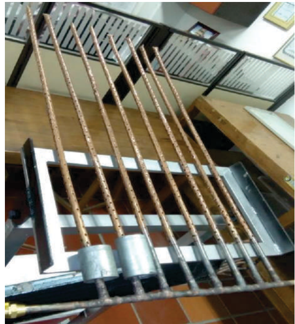
FIGURA 11 COLECTOR EN PROCESO DE CONSTRUCCIÓN, FUENTE: AUTOR
