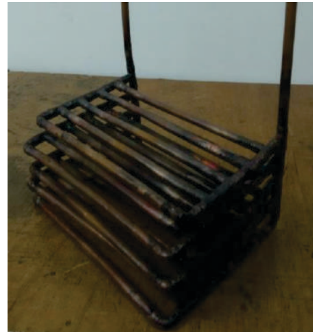
FIGURA 9 EVAPORADOR CONSTRUIDO. FUENTE AUTOR
