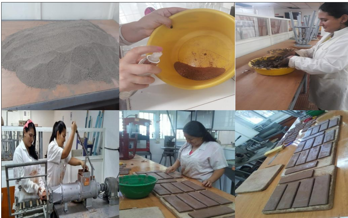
Figura 6. Proceso de conformado de los especímenes
