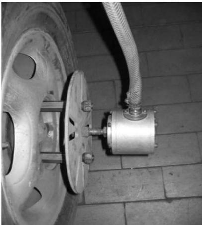
Fig. 3. Equipo de quinta rueda utilizado en las pruebas.
