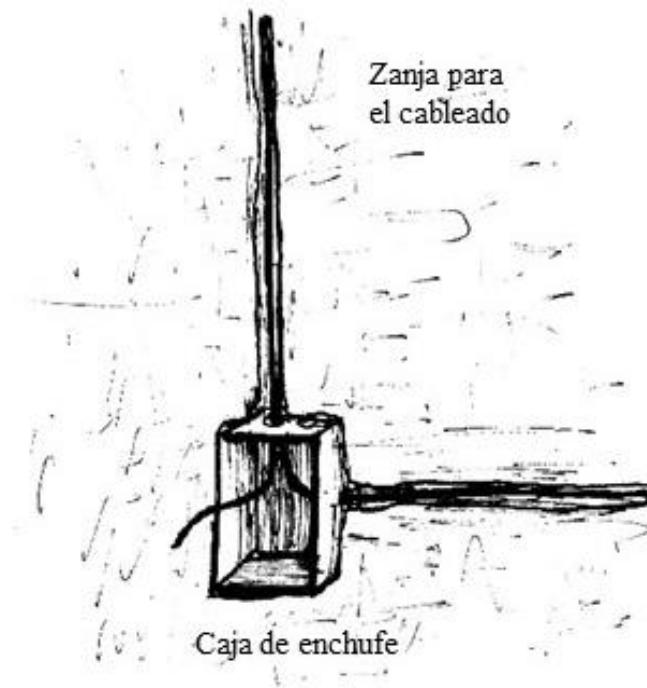
Figura 50. Instalaciones eléctricas en el muro de cob.
