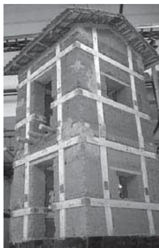
Fotografía 19. Ensayo a escala reducida. Casa de tapia de dos pisos reforzada con maderas. Yamín et al. (2007).
