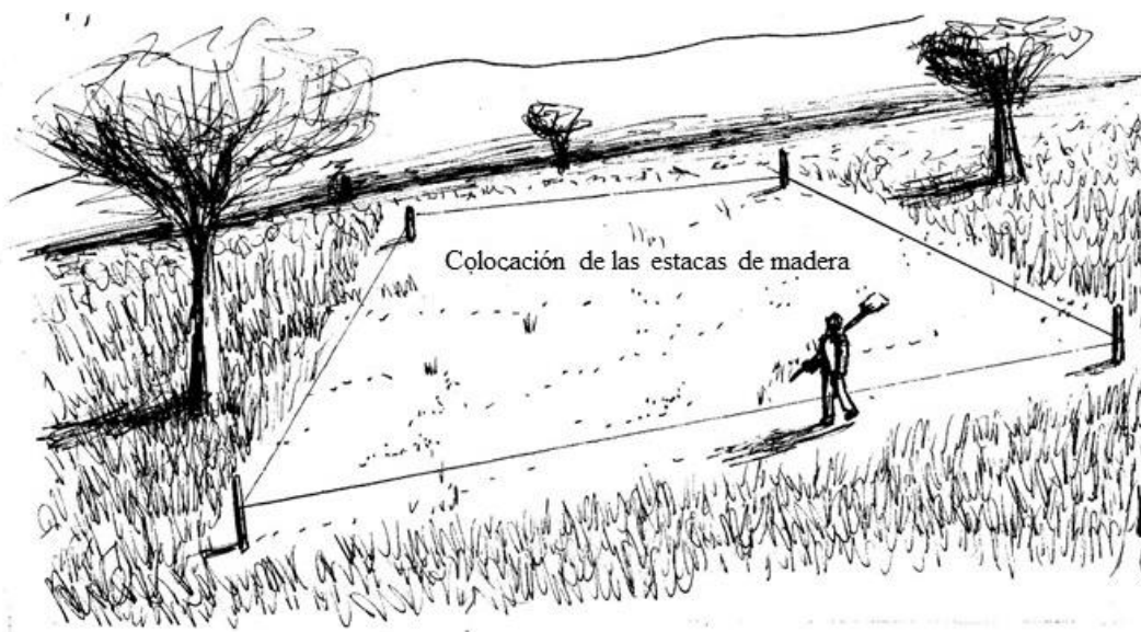
Figura 20. Definición del área a nivelar.
