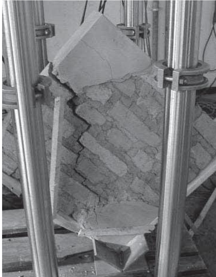
Fotografía 24. Ensayo de tracción diagonal. Yamín et al. (2007).
