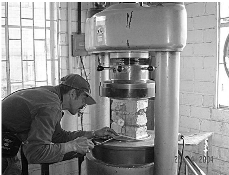
Fotografía 23. Caracterización mecánica en la ECI: compresión sobre muretes de adobe. Rivera (2012).
