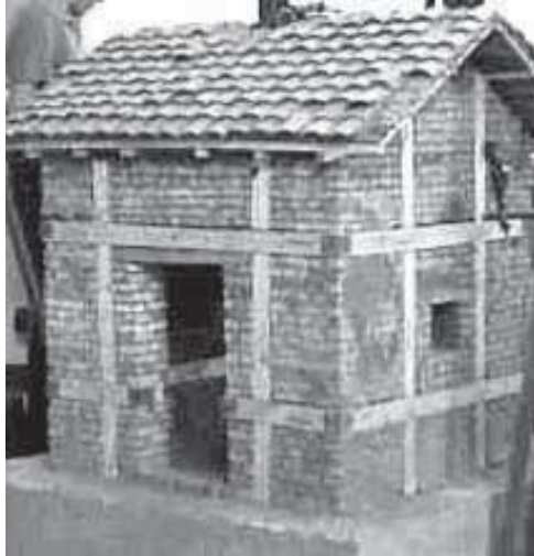
Fotografía 25. Fotografía ensayo a escala reducida. Casa de adobe reforzada con maderas. Yamín et al. (2007).
