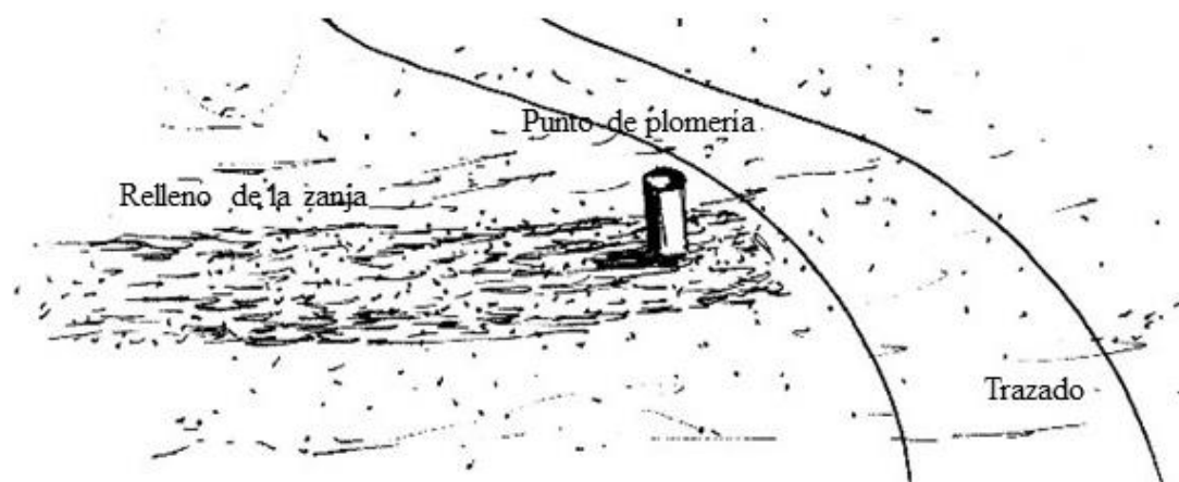
Figura 28. Tubería sobresaliente para puntos de instalación.
