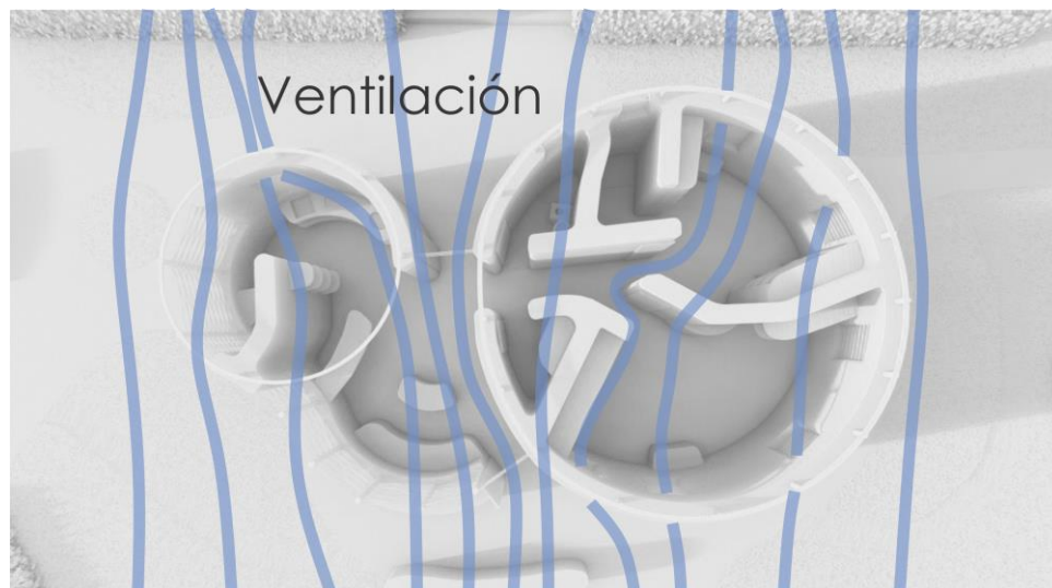
Figura 78. Dinámica de ventilación.
