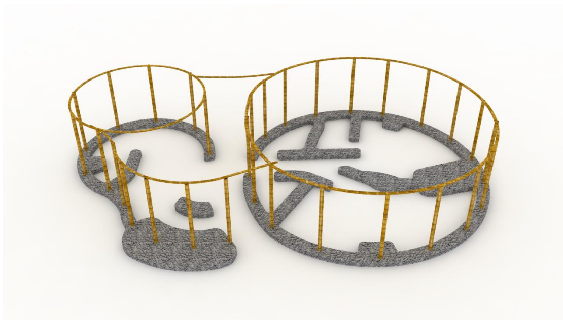
Figura 72. Estructura de guadua y viga de amarre.
