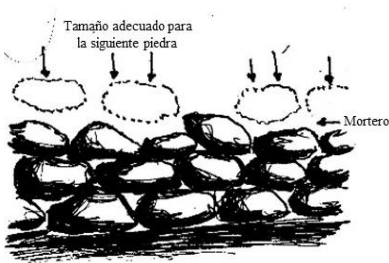
Figura 32. Técnica para la construcción del cimiento.
