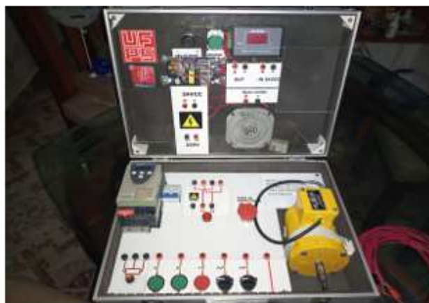
Figure 1 Módulo didáctico para entrenamiento del control de velocidad para motores eléctricos
