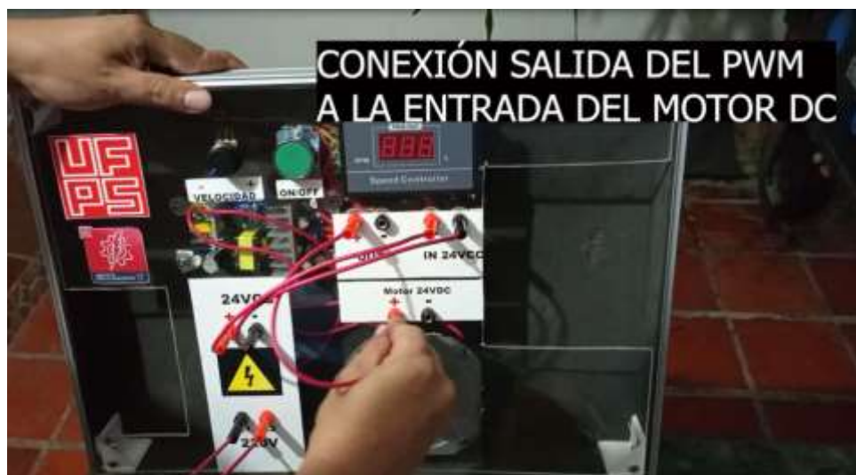
Figura 40. Conexión voltaje controlado al Motor DC
