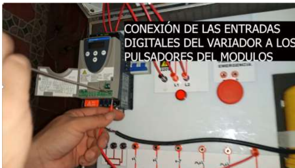
Figura 35. Conexión de las entradas digitales del variador
