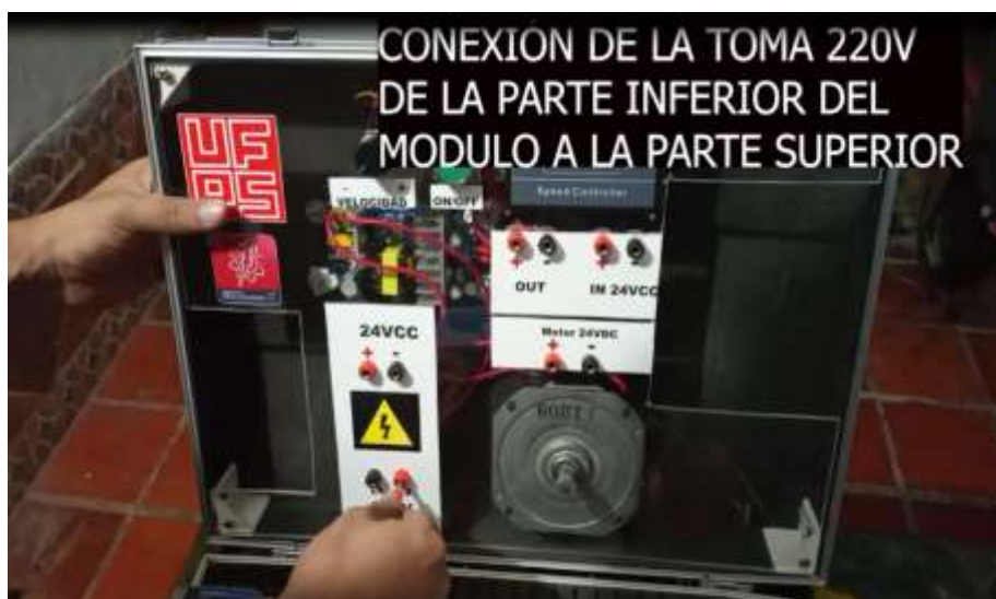
Figura 38. Conexión fuente 220V
