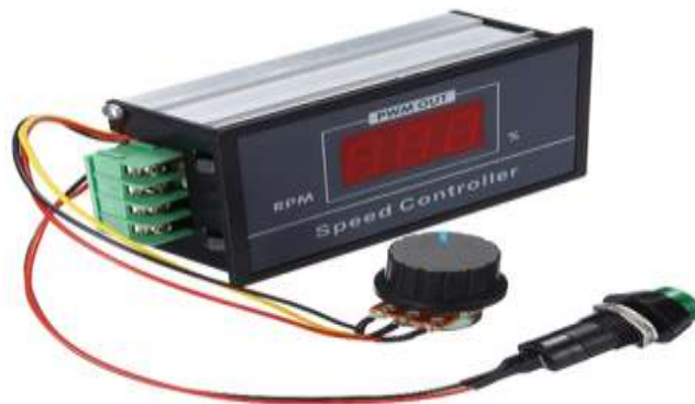
Figura 20. Controlador PWM ajustable con pantalla digital DC 6-60V a 30A
