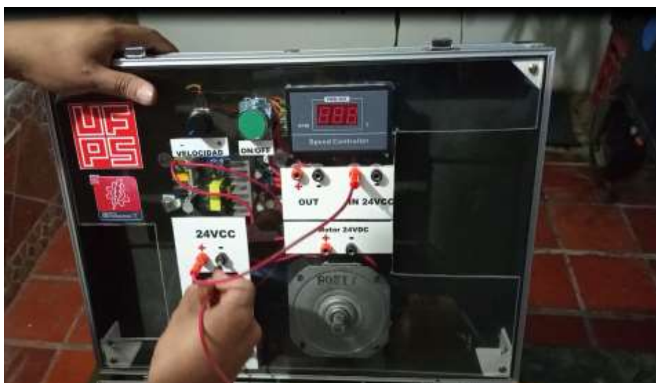
Figura 39. Conexión voltaje PWM
