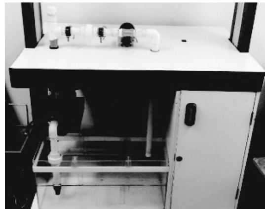
Figura 1. Banco de pruebas para bombas centrífugas
